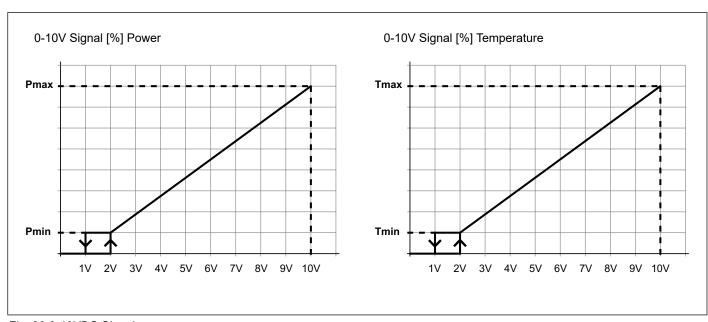
Fig. 20 0-10VDC Signal
