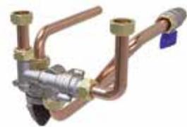
Il Kit solare per caldaie istantanee permette di bypassare la caldaia nel caso in cui la temperatura dell'acqua dal serbatoio solare sia maggiore di 48 °C. È costituito da una deviatrice termostatica e da una miscelatrice termostatica regolabile, fra loro integrate. Nel caso in cui in sede di ordine di un KIT SULPACK EASY venga ordinato il kit solare per caldaia la valvola miscelatrice non sarà fornita e verrà automaticamente defalcata dal costo del pacchetto.
