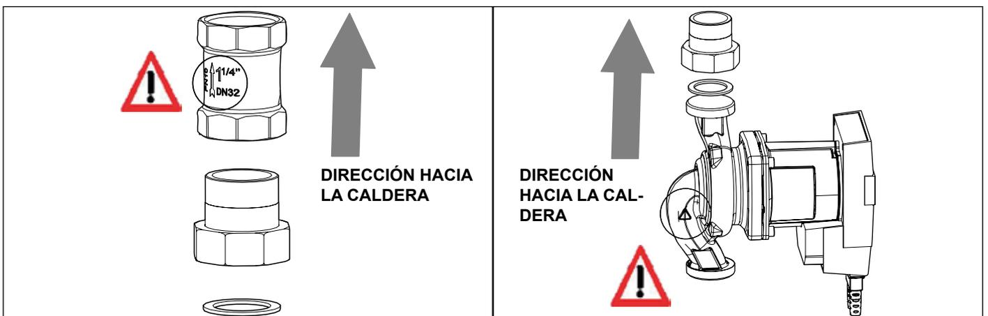
Fijar los componentes de la parte hidráulica prestando atención al sentido de montaje de la válvula antirretorno y al sentido de montaje del circulador.
