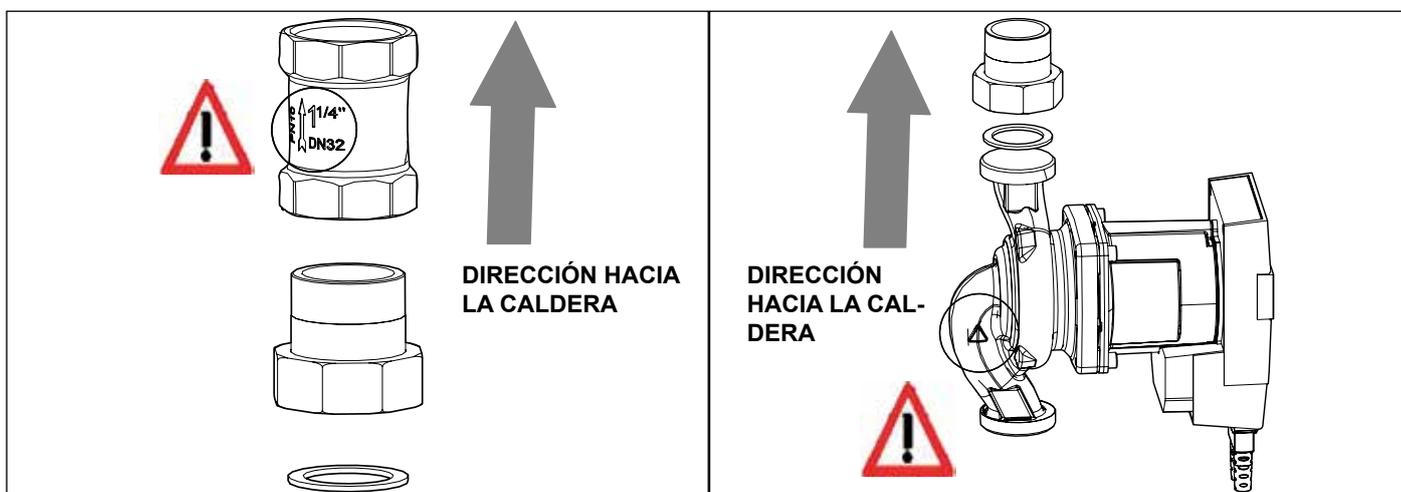
Fijar los componentes de la parte hidráulica prestando atención al sentido de montaje de la válvula antirretorno y al sentido de montaje del circulador.
