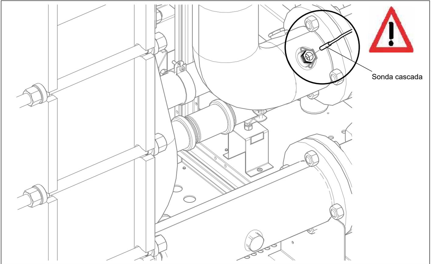
Introducir la sonda de cascada en la posición indicada en la imagen.
