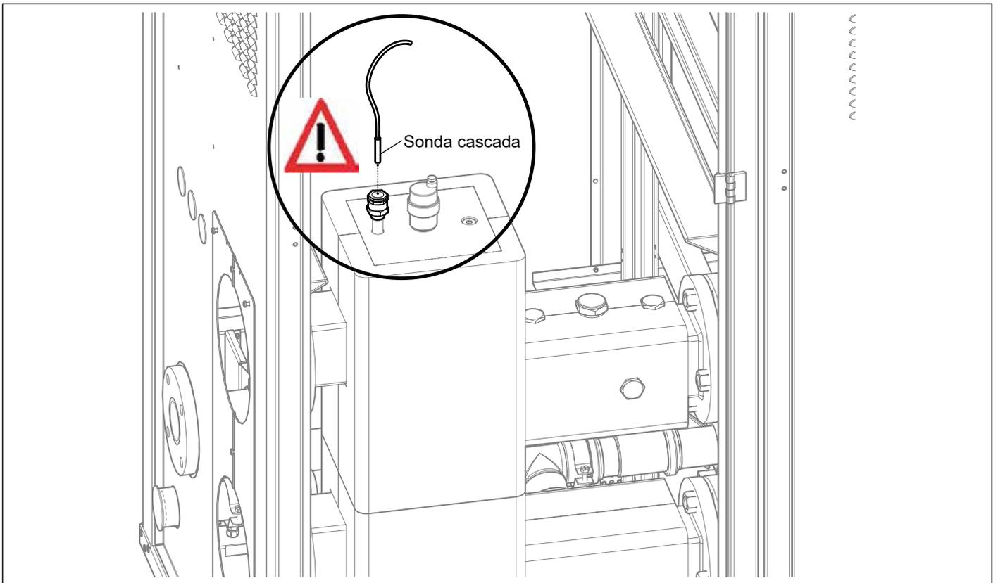
Introducir la sonda de cascada en la posición indicada en la imagen.
