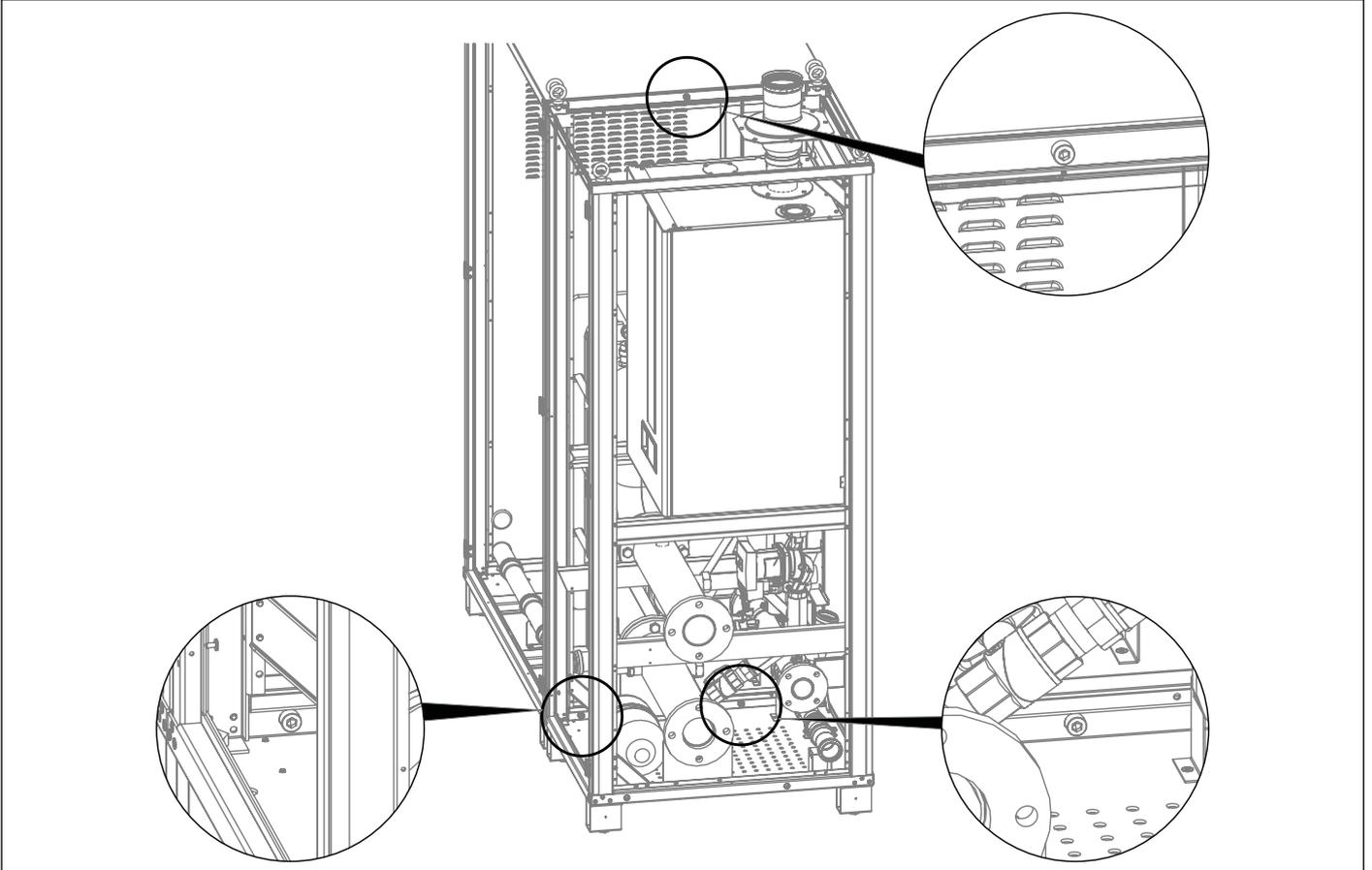
Bloquear el armario inicial con el armario que contiene el intercambiador de placas con los tornillos suministrados.
