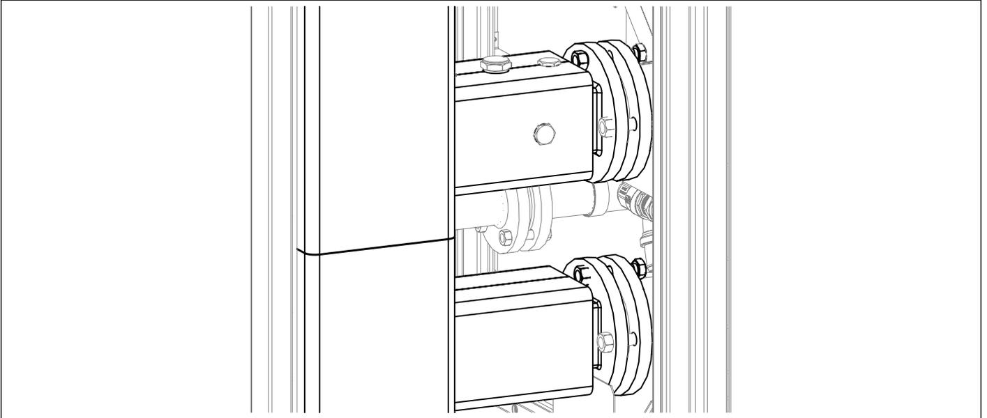
Fijar el colector de ida y de retorno con los tornillos y las tuercas interponiendo las juntas entre los mismos.
