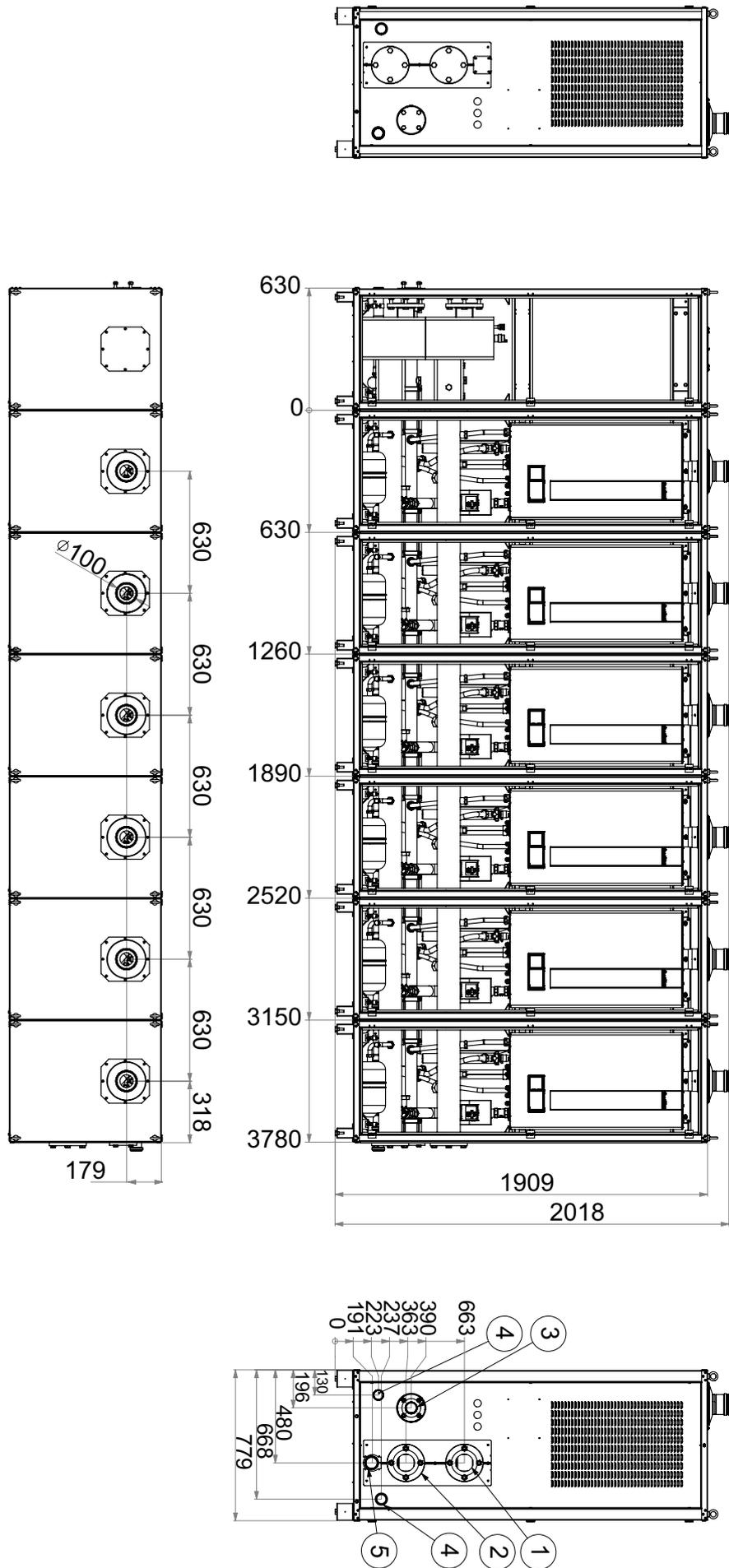
Fig. 8 Combinación 120-150 separador hidráulico izquierdo en armario
