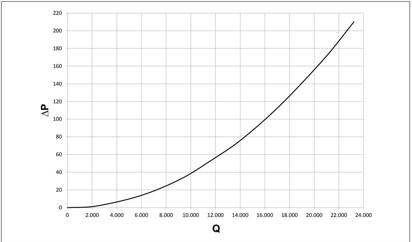
Fig. 22 Pérdida de carga intercambiador de placas de 540 kW lado primario y lado secundario
