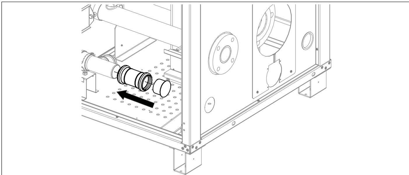
Montar el tramo de tubo de descarga de condensación y el relativo tapón de cierre como se indica en la imagen.
