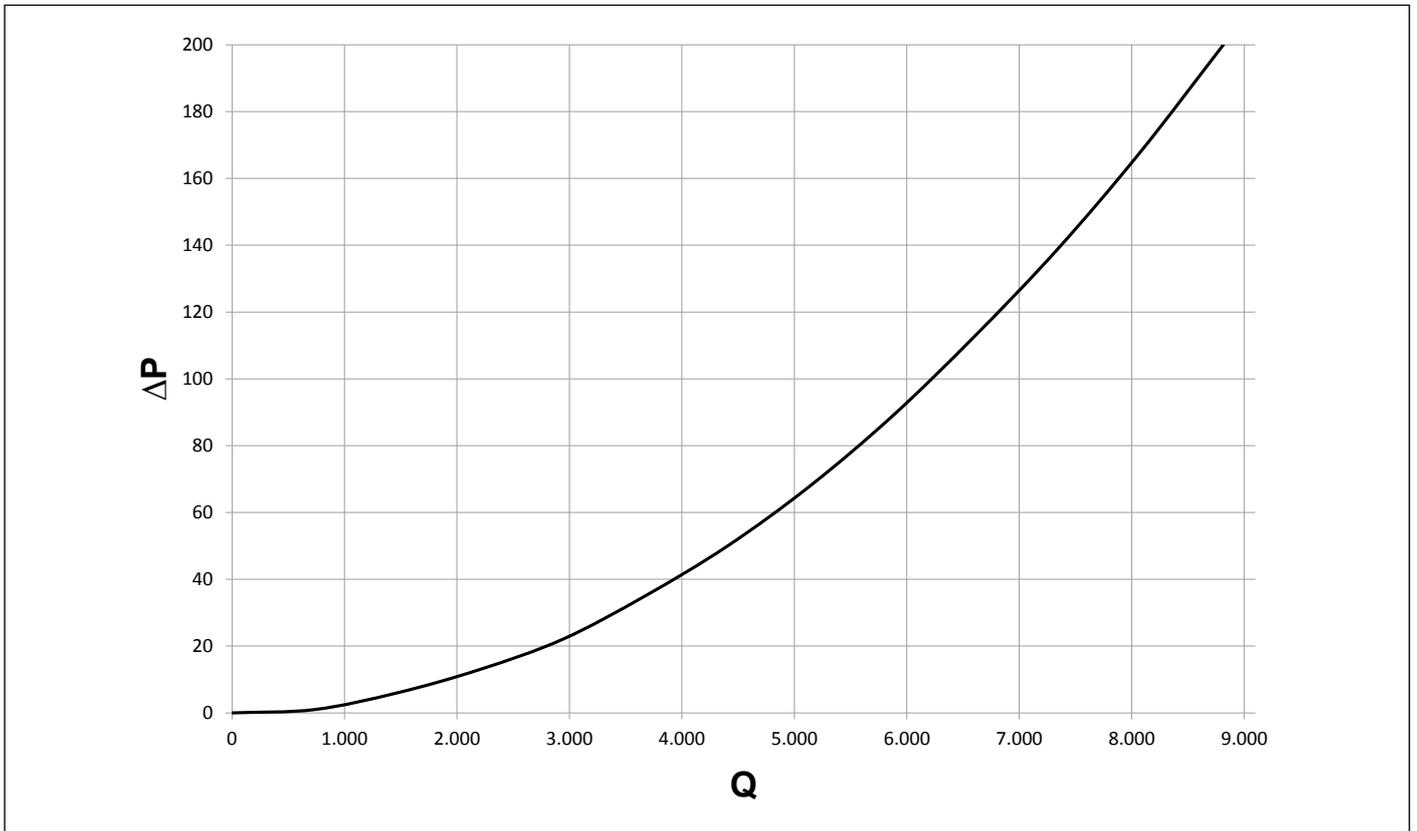
Fig. 18 Pérdida de carga intercambiador de placas de 205 kW lado primario y lado secundario
