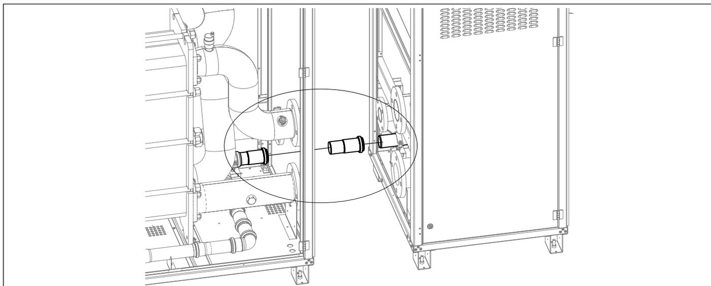
Ensamblar el tubo suministrado en la descarga de condensación como indica la figura.
