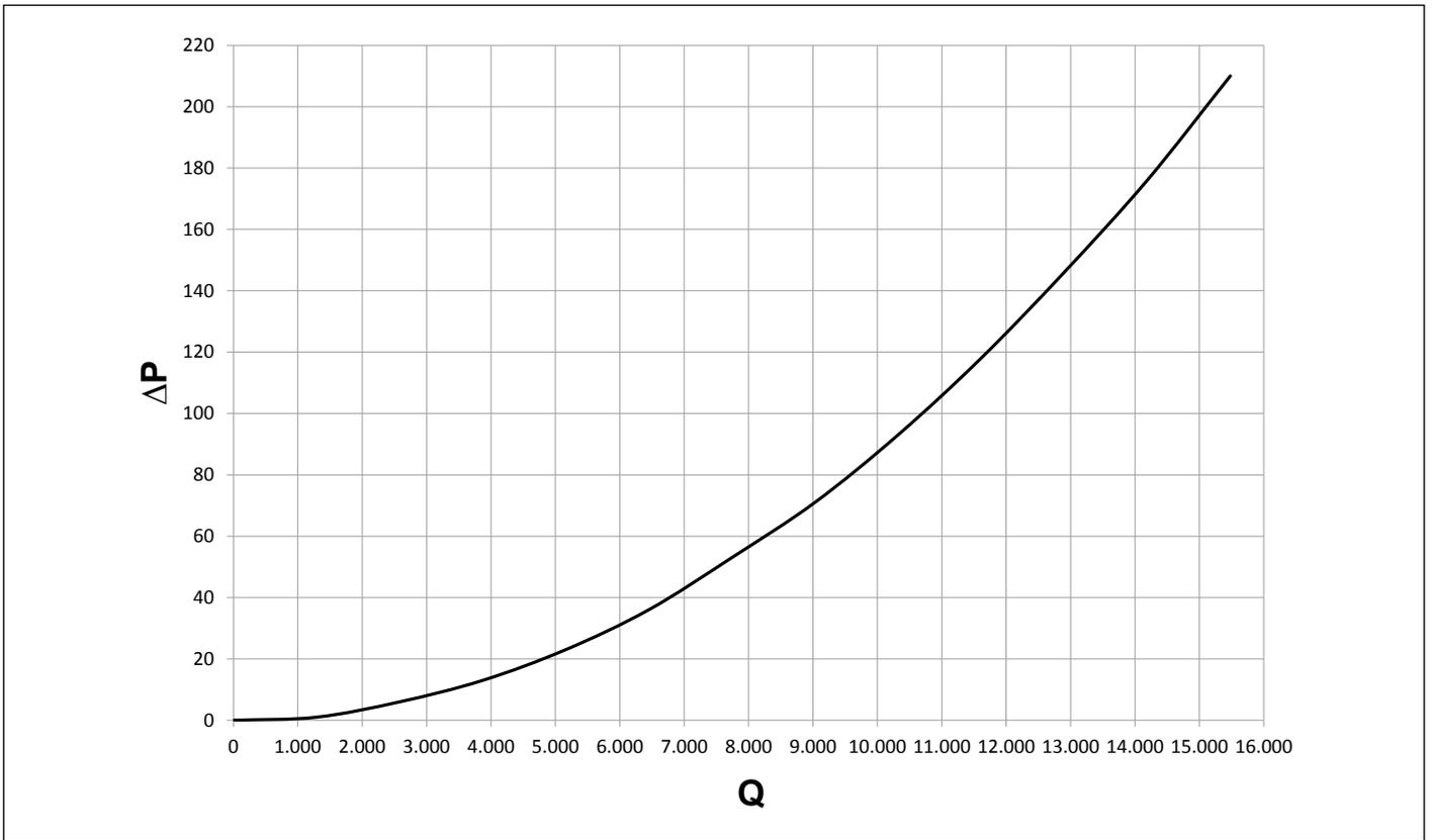
Fig. 20 Pérdida de carga intercambiador de placas de 360 kW lado primario y lado secundario
