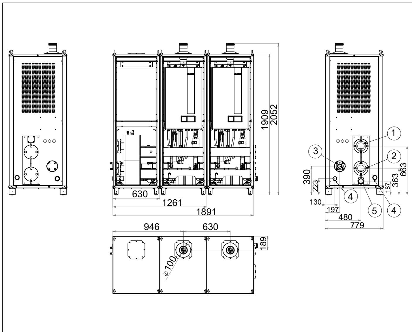
Fig. 4 Combinación 45-60 separador hidráulico izquierdo en armario
