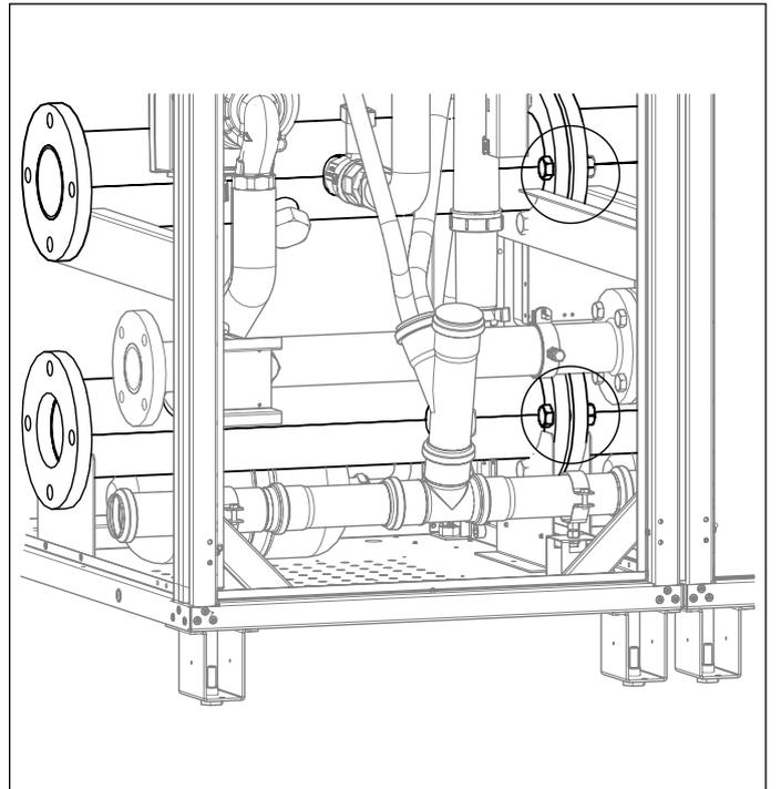
Ajustar los tornillos presentes en los colectores del armario intermedio.
