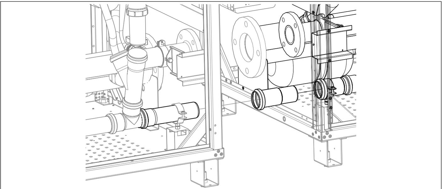
Ensamblar el tubo suministrado en la descarga de condensación como indica la figura.
