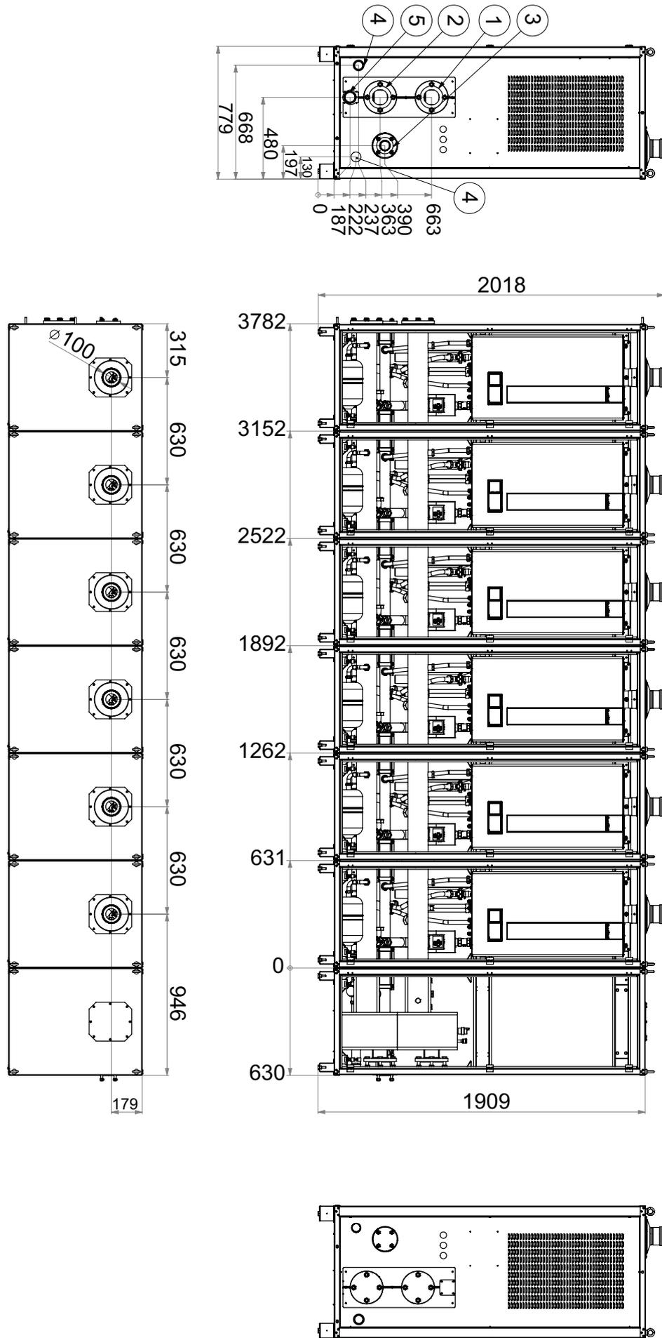
Fig. 9 Combinación 120-150 separador hidráulico derecho en armario
