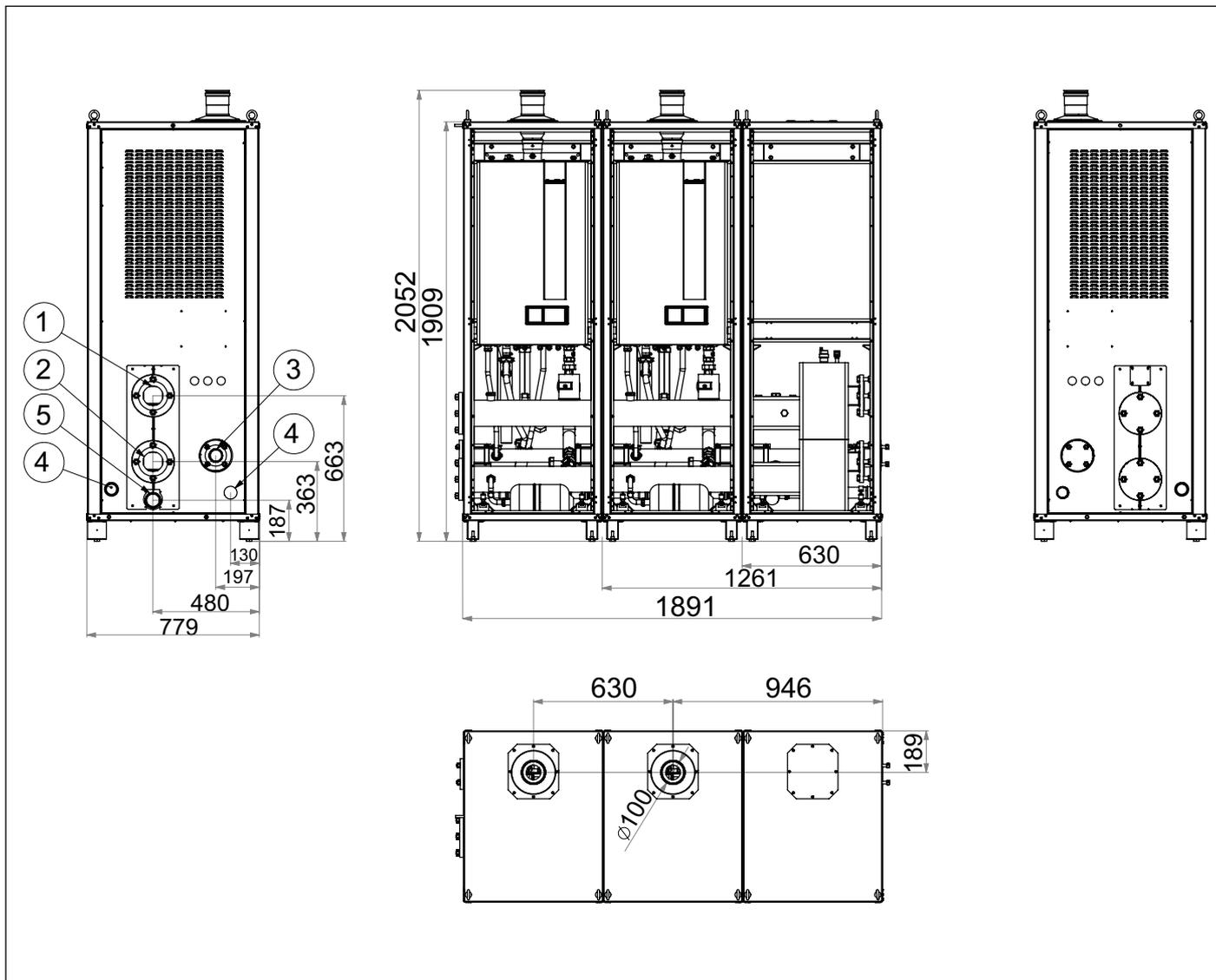
Fig. 5 Combinación 45-60 separador hidráulico derecho en armario
