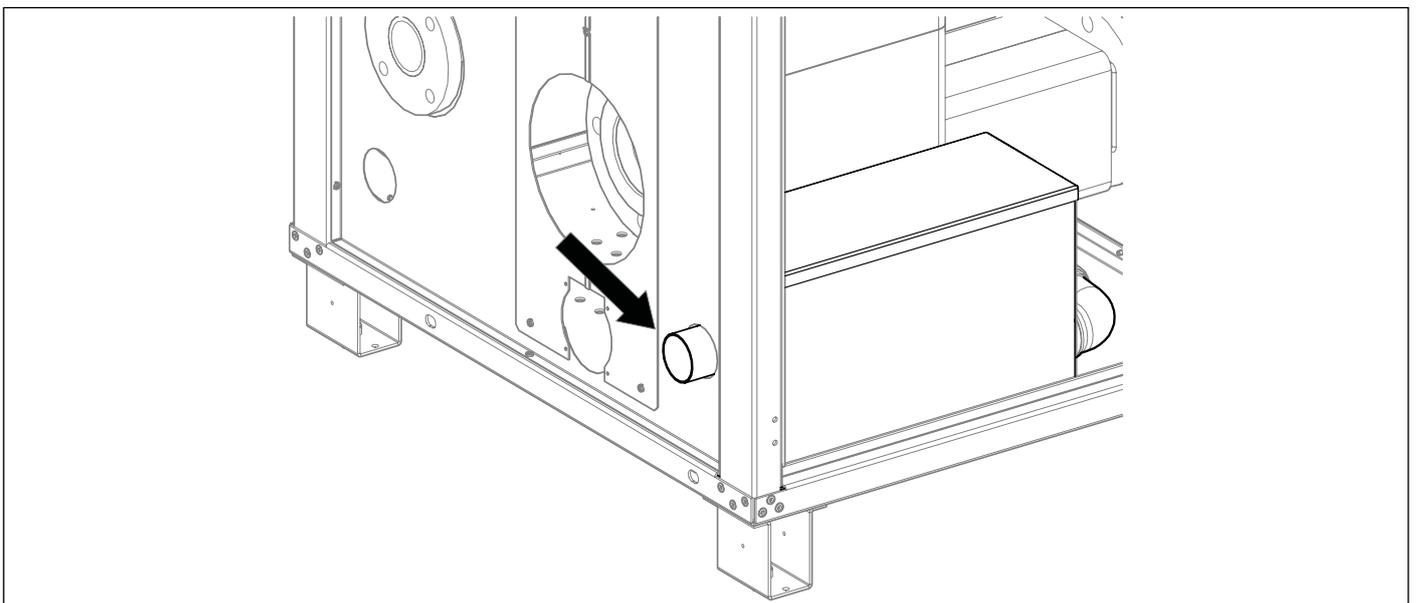
Fijar el neutralizador de la condensación como se indica en la imagen.
