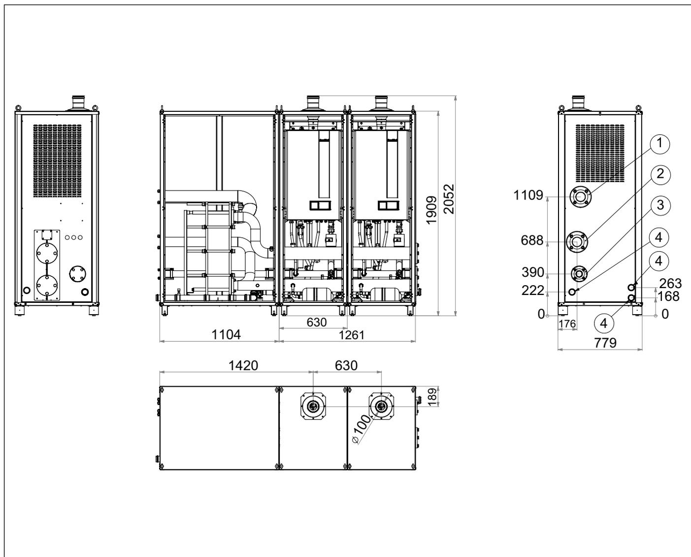
Fig. 10 Combinación 45-60 intercambiador de placas izquierdo en armario
