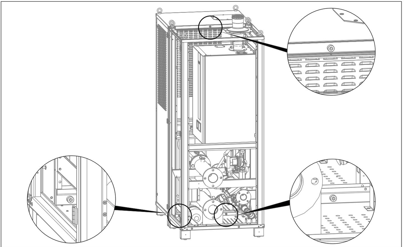
Bloquear el armario inicial con el armario que contiene el separador hidráulico con los tornillos suministrados.
