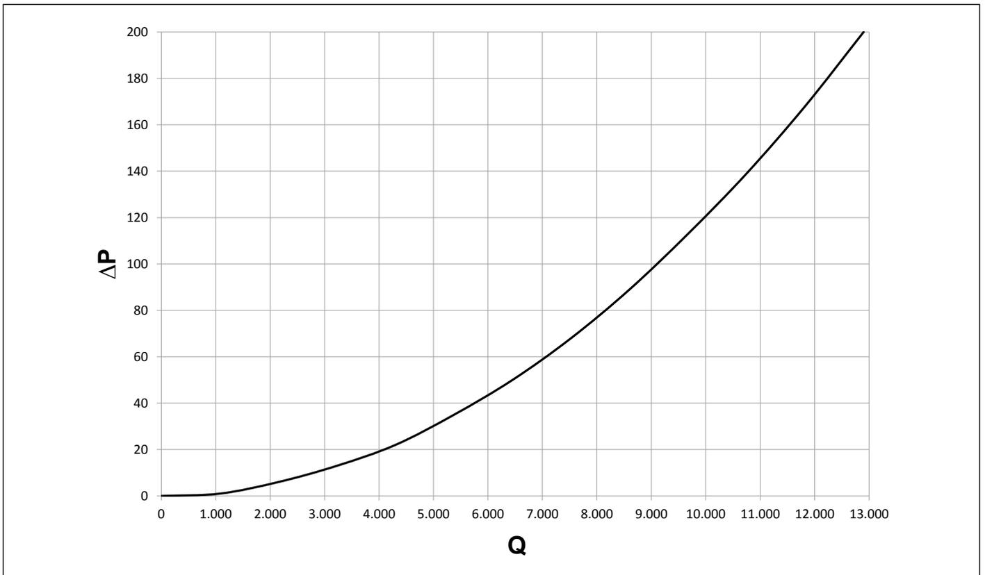
Fig. 19 Pérdida de carga intercambiador de placas de 300 kW lado primario y lado secundario
