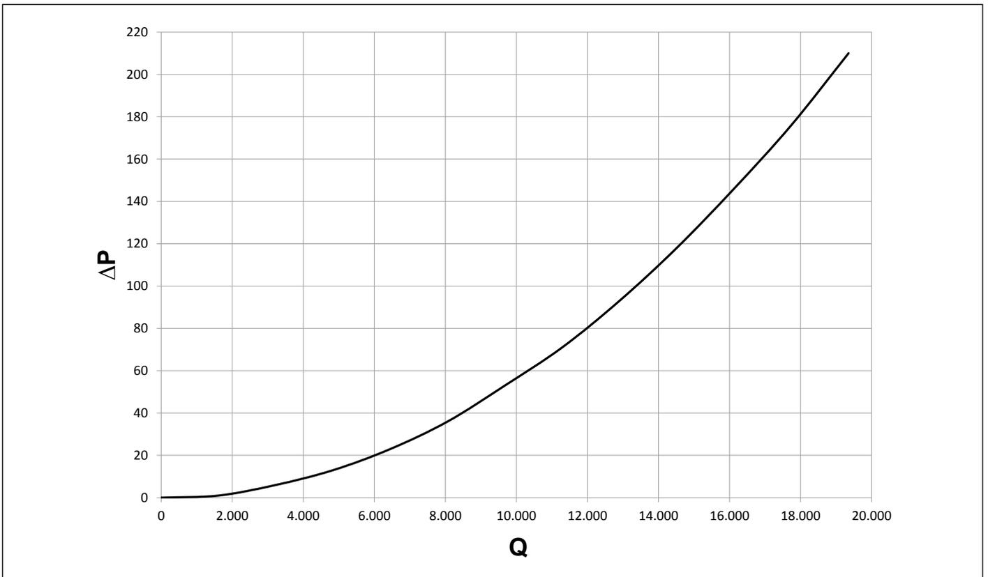
Fig. 21 Pérdida de carga intercambiador de placas de 450 kW lado primario y lado secundario
