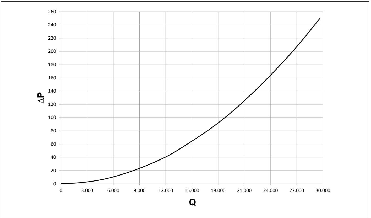
Fig. 24 Pérdida de carga intercambiador de placas de 690 kW lado primario y lado secundario
