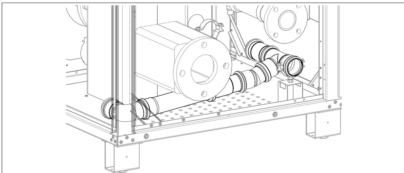
Ensamblar la descarga de la condensación siguiendo las indicaciones de la figura anterior.
