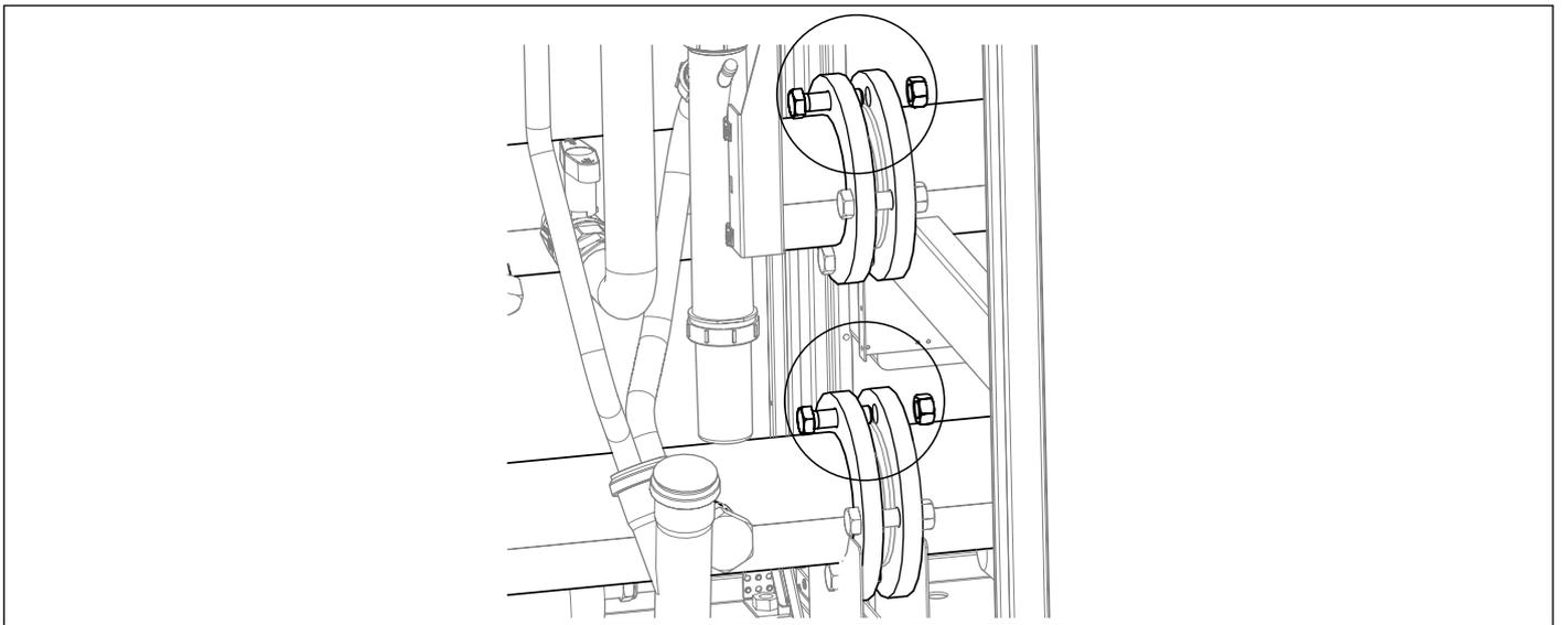
Fijar el colector de ida y de retorno con los tornillos y las tuercas interponiendo las juntas entre los mismos.
