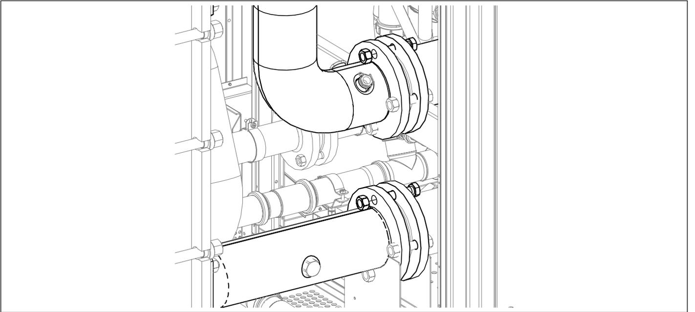
Fijar el colector de ida y de retorno con los tornillos y las tuercas interponiendo las juntas entre los mismos.
