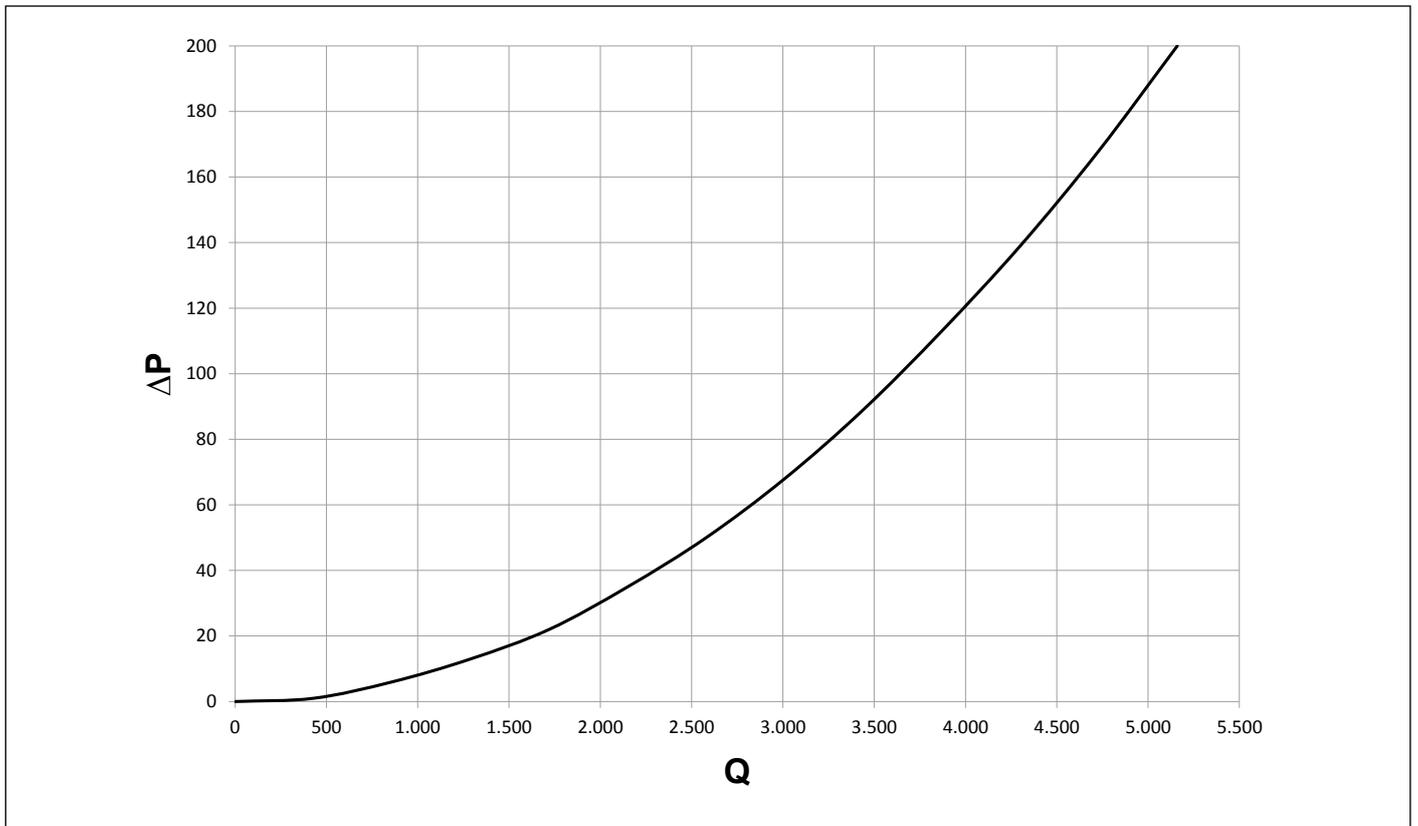
Fig. 17 Pérdida de carga intercambiador de placas de 120 kW lado primario y lado secundario
