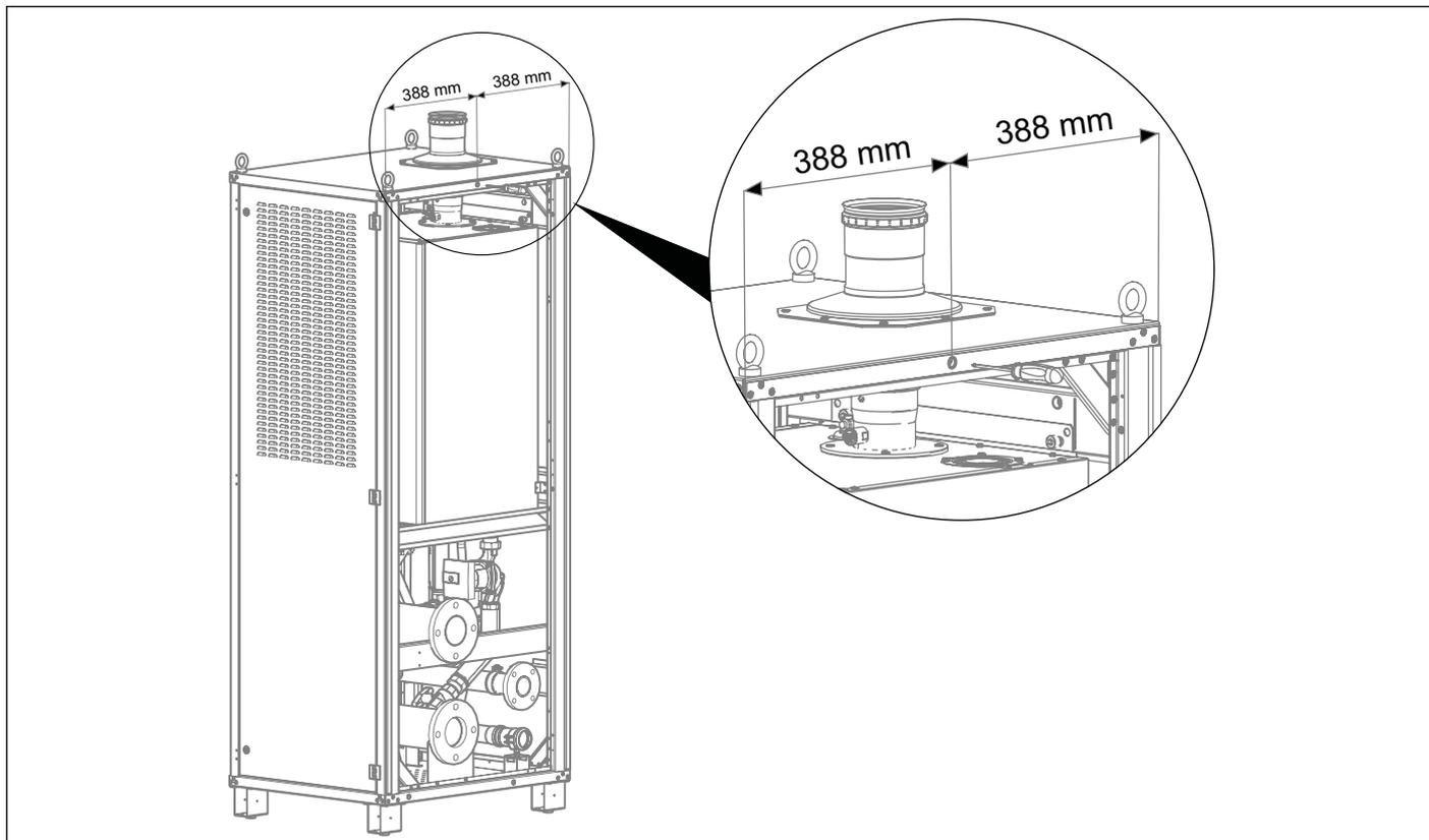
Efectuar un orificio en la junta superior con un punzón en coincidencia con el orificio de introducción del tornillo.
