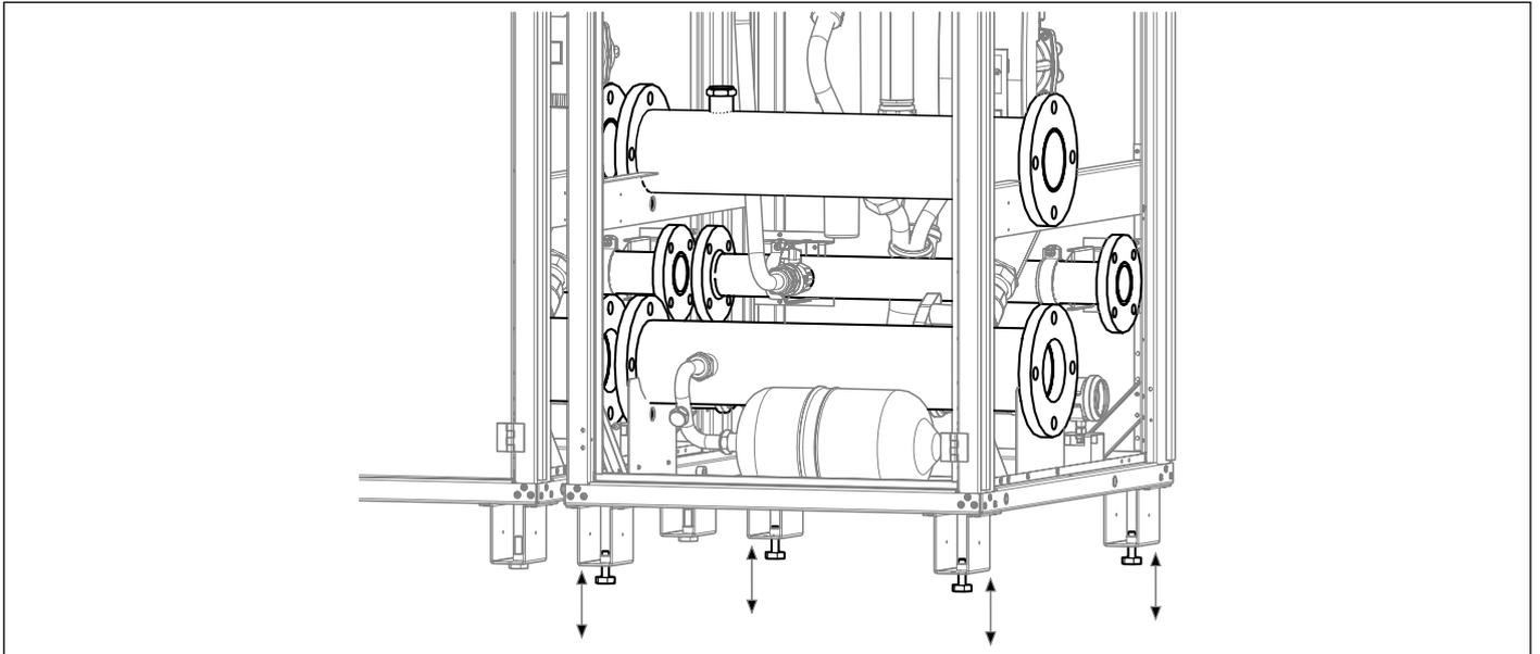
Alinear el colector de ida, el colector de retorno y el tubo de gas con los colectores presentes en el armario adyacente, mediante las cuatro bases del armario intermedio.
