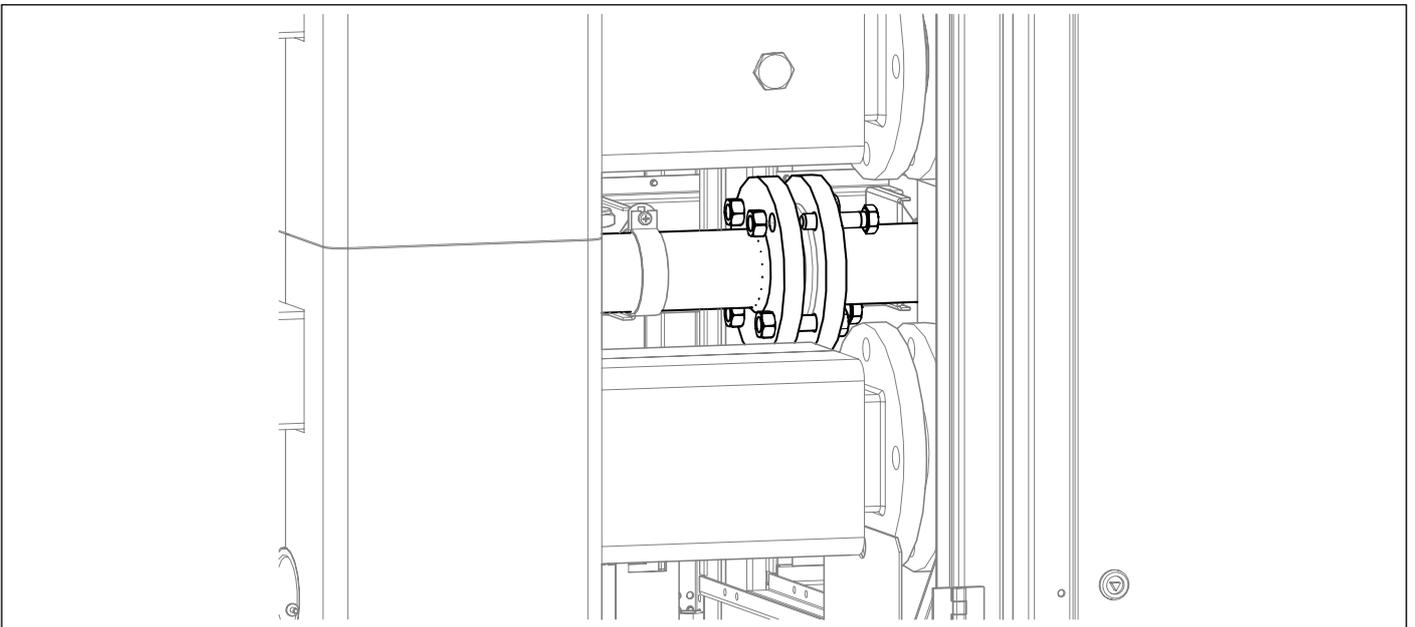
Fijar el colector gas con los tornillos y las tuercas interponiendo la junta entre los dos colectores.
