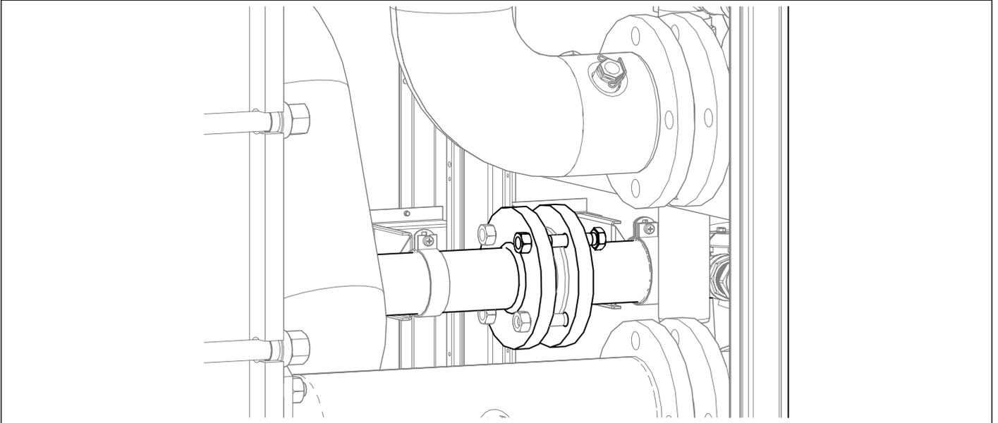
Fijar el colector gas con los tornillos y las tuercas interponiendo la junta entre los dos colectores.
