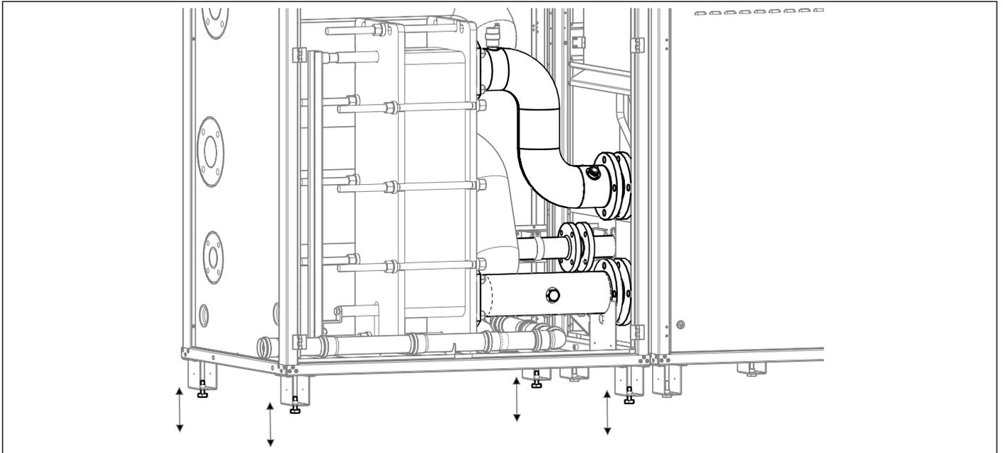
Alinear el colector de ida, el colector de retorno y el tubo de gas con los colectores presentes en el armario adyacente, mediante las cuatro bases del armario que contiene el intercambiador de placas.
