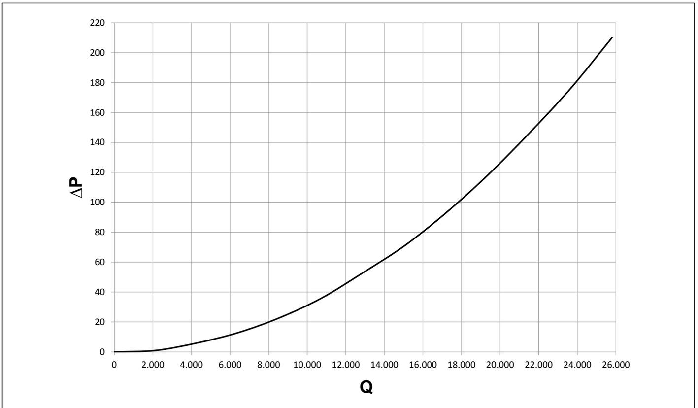
Fig. 23 Pérdida de carga intercambiador de placas de 600 kW lado primario y lado secundario
