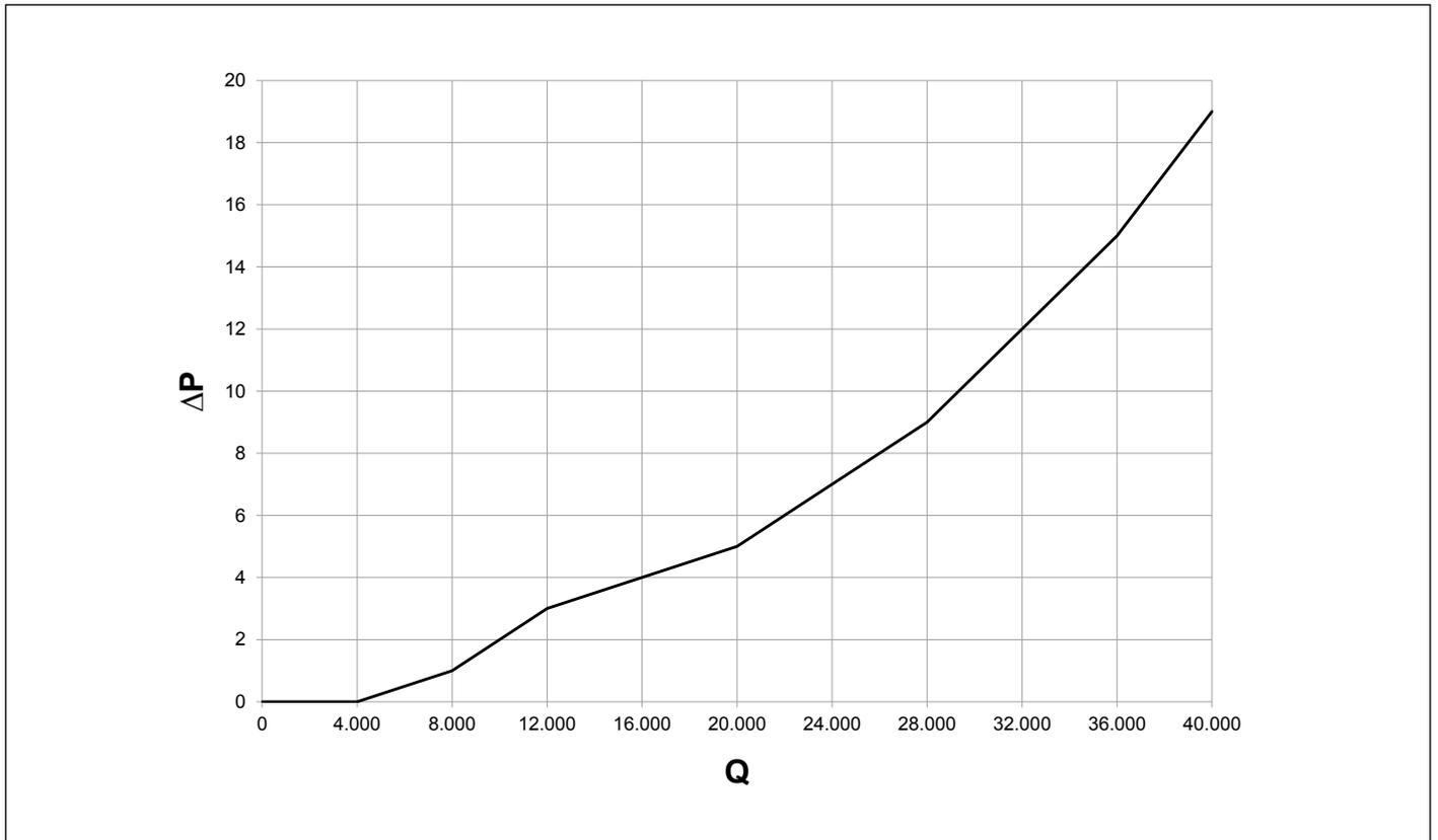
Fig. 16 Pérdidas de carga separador hidráulico lado instalación
