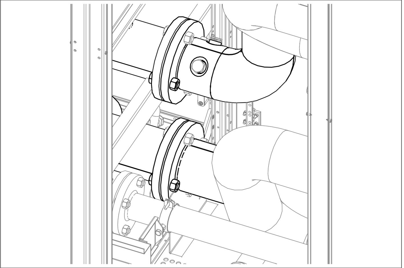
Ajustar los tornillos presentes en los colectores del armario intermedio.
