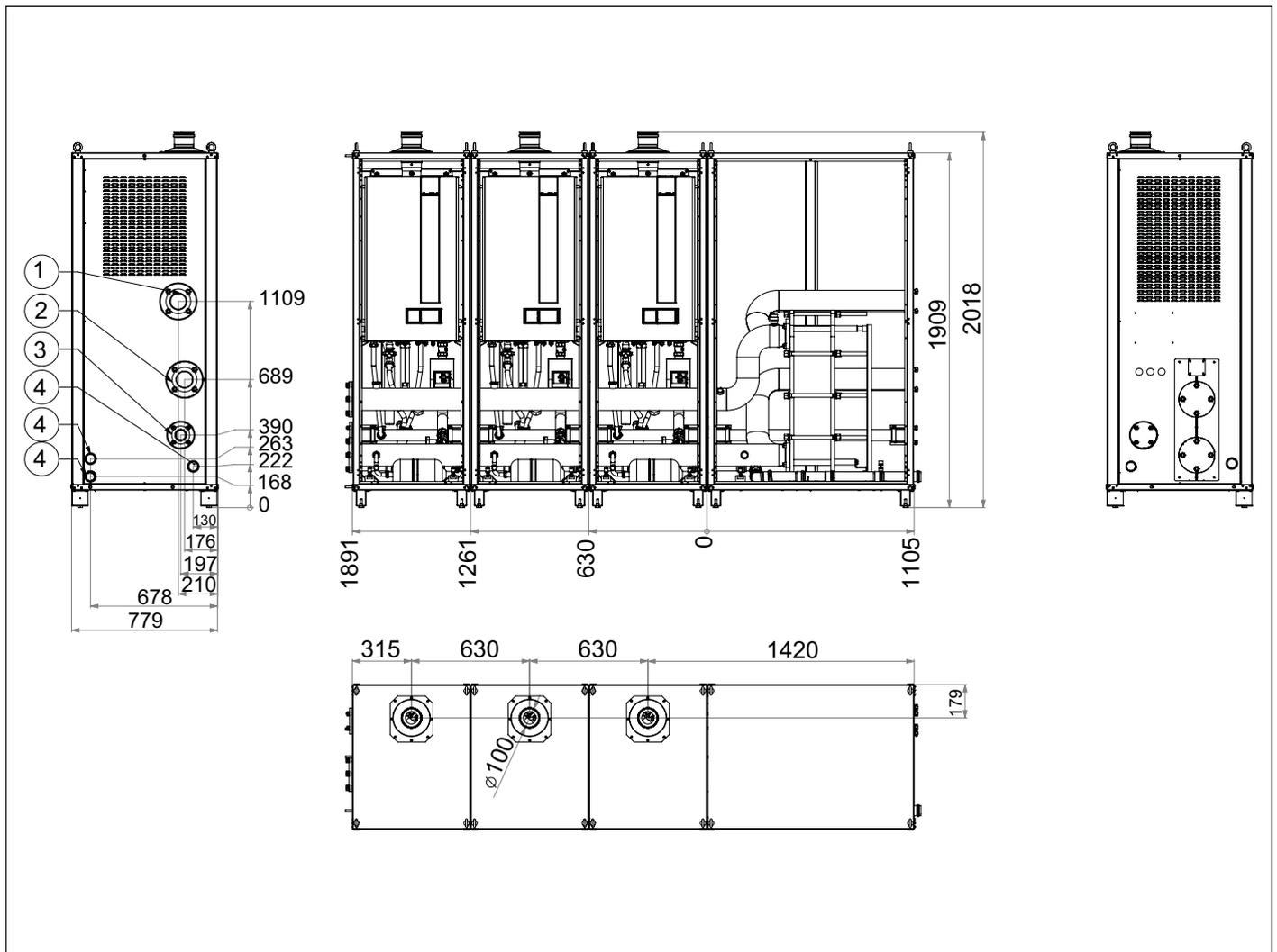
Fig. 13 Combinación 85-120 intercambiador de placas derecho en armario
