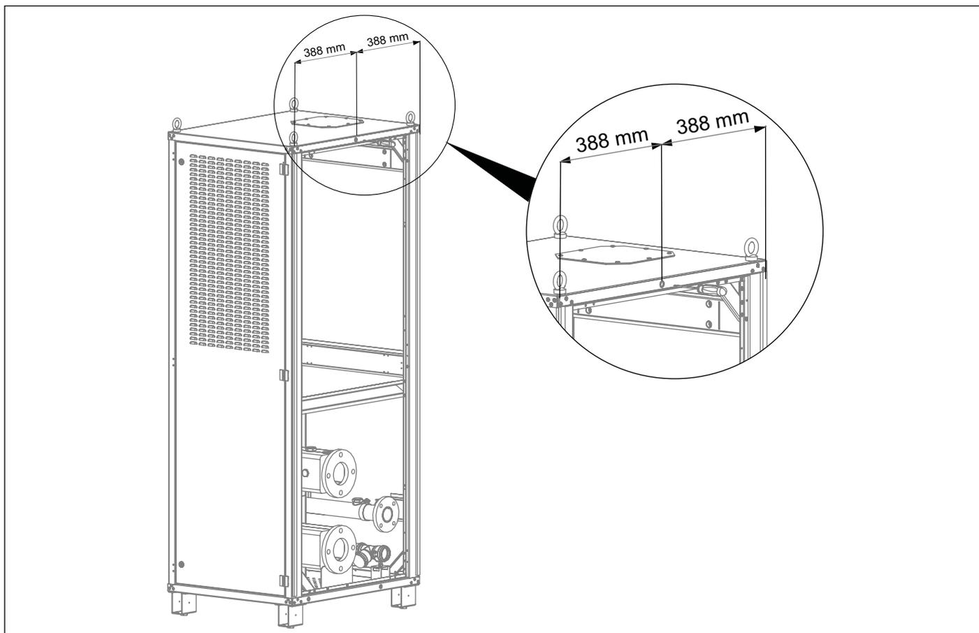
Efectuar un orificio en la junta superior con un punzón en coincidencia con el orificio de introducción del tornillo.
