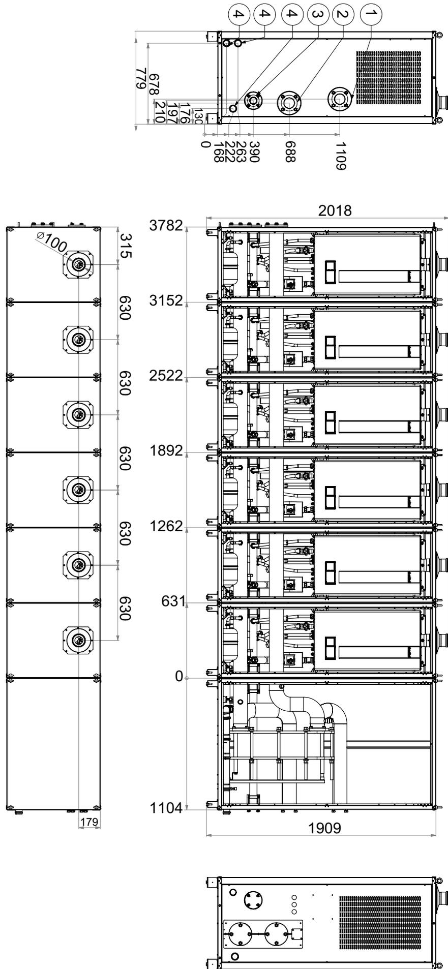
Fig. 15 Combinación 120-150 intercambiador de placas derecho en armario
