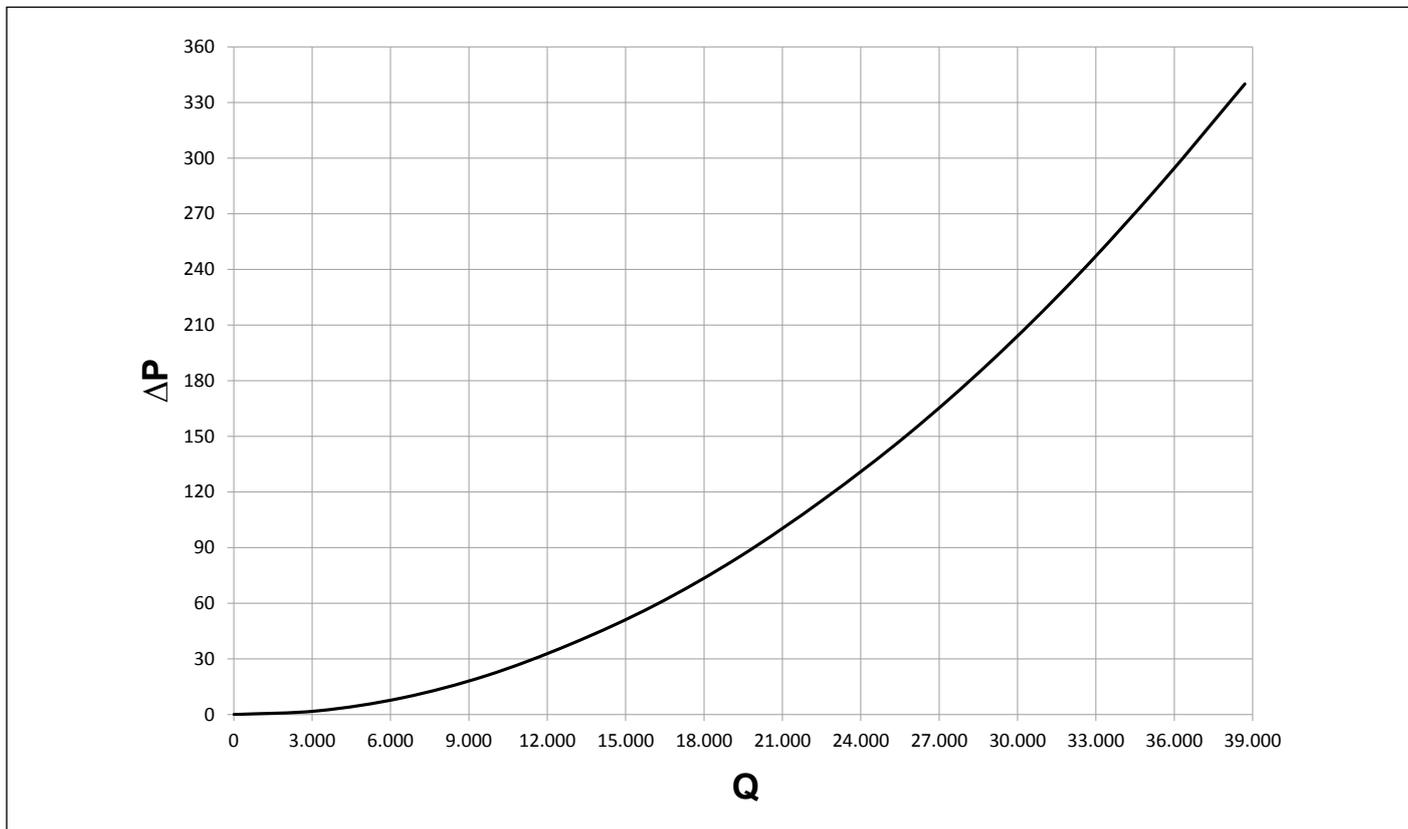
Fig. 26 Pérdida de carga intercambiador de placas de 900 kW lado primario y lado secundario
