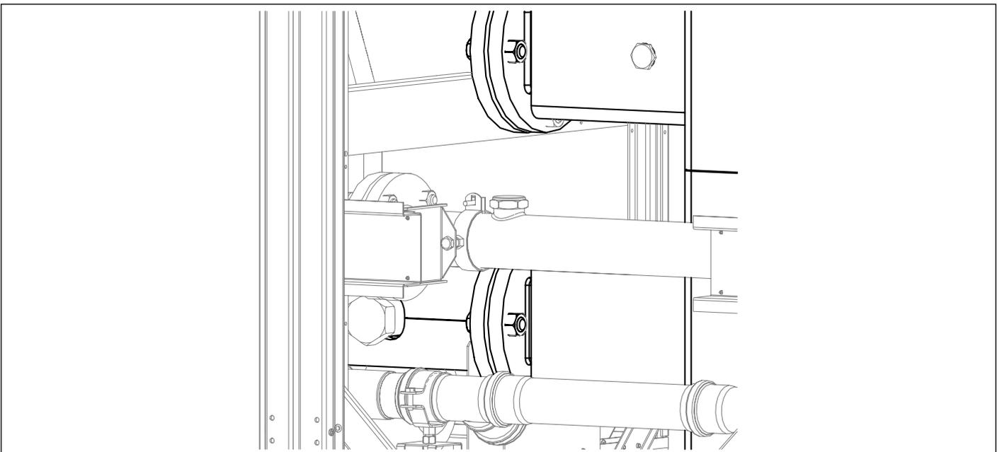
Ajustar los tornillos presentes en los colectores del armario intermedio.
