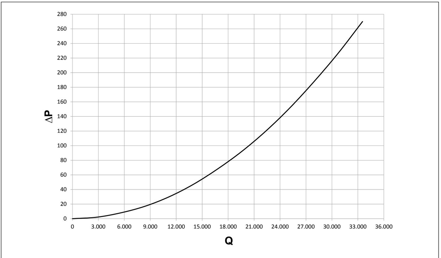
Fig. 25 Pérdida de carga intercambiador de placas de 780 kW lado primario y lado secundario
