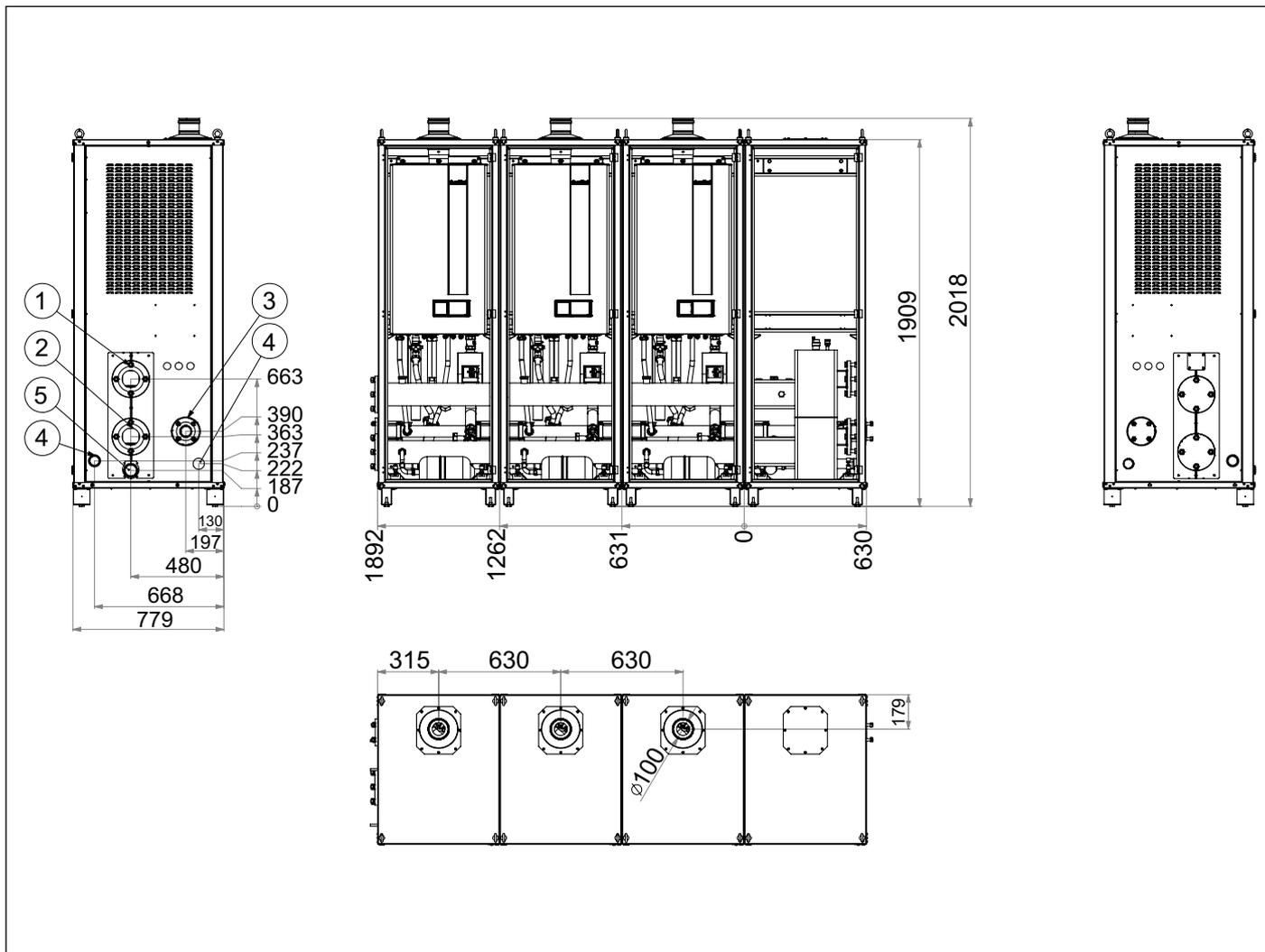
Fig. 7 Combinación 85-120 separador hidráulico derecho en armario
