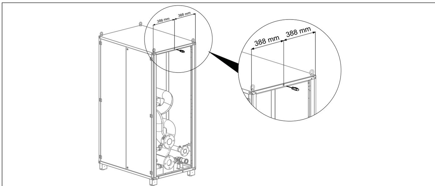
Efectuar un orificio en la junta superior con un punzón en coincidencia con el orificio de introducción del tornillo.
