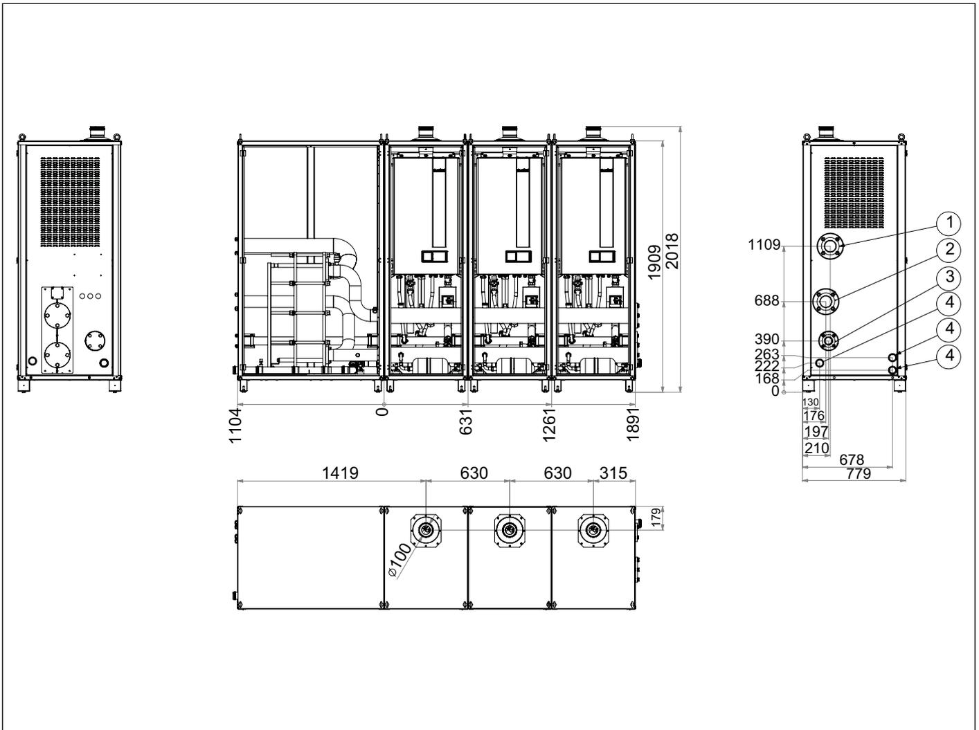
Fig. 12 Combinación 85-120 intercambiador de placas izquierdo en armario
