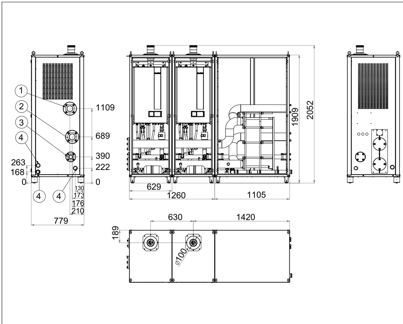
Fig. 11 Combinación 45-60 intercambiador de placas derecho en armario
