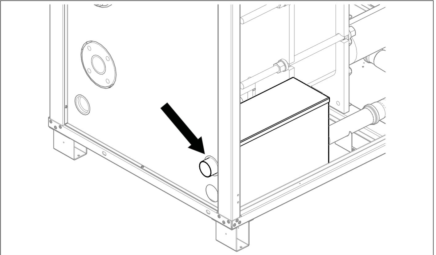
Fijar el neutralizador de la condensación como se indica en la imagen.
