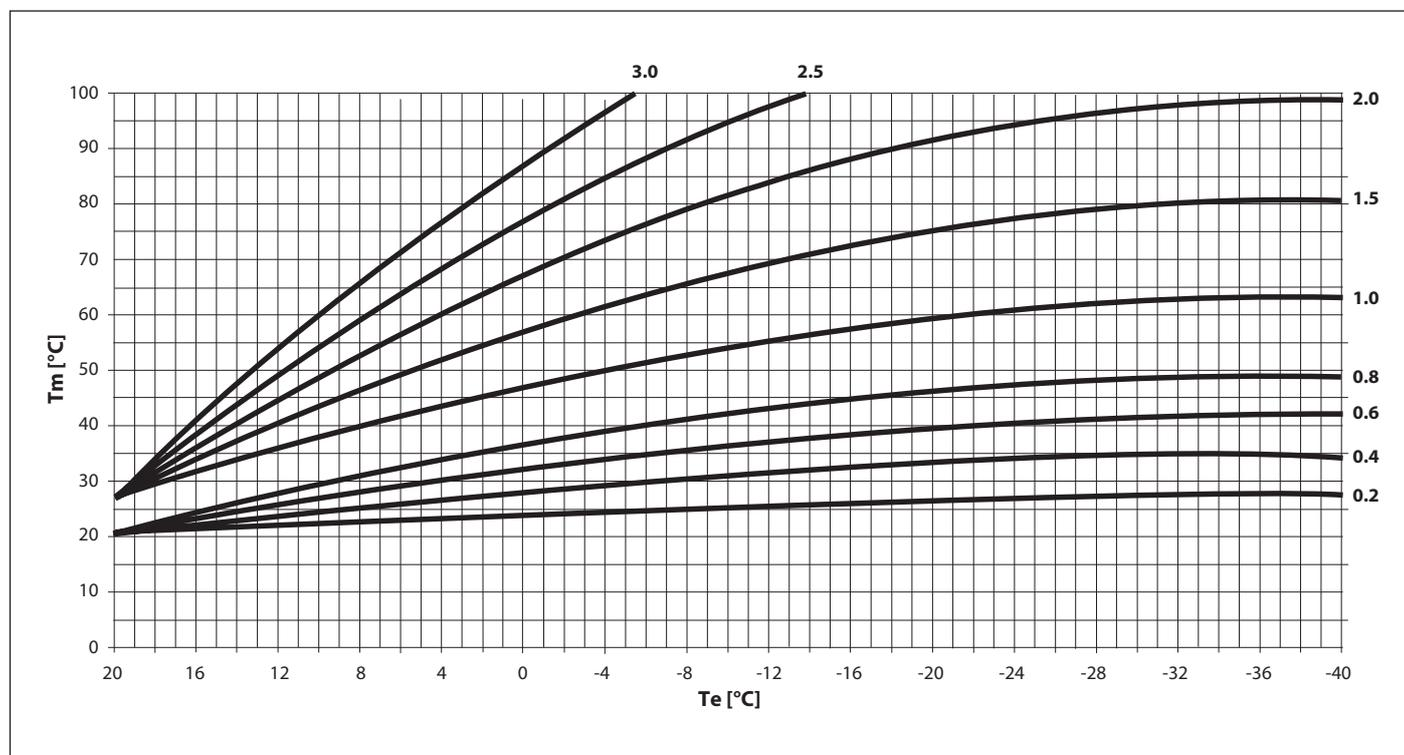
Fig. 9 Curve di termoregolazione
