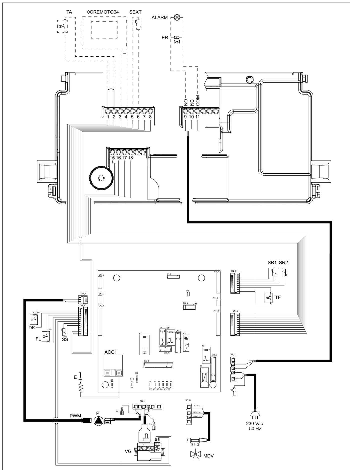
Fig. 11 Schema elettrico
