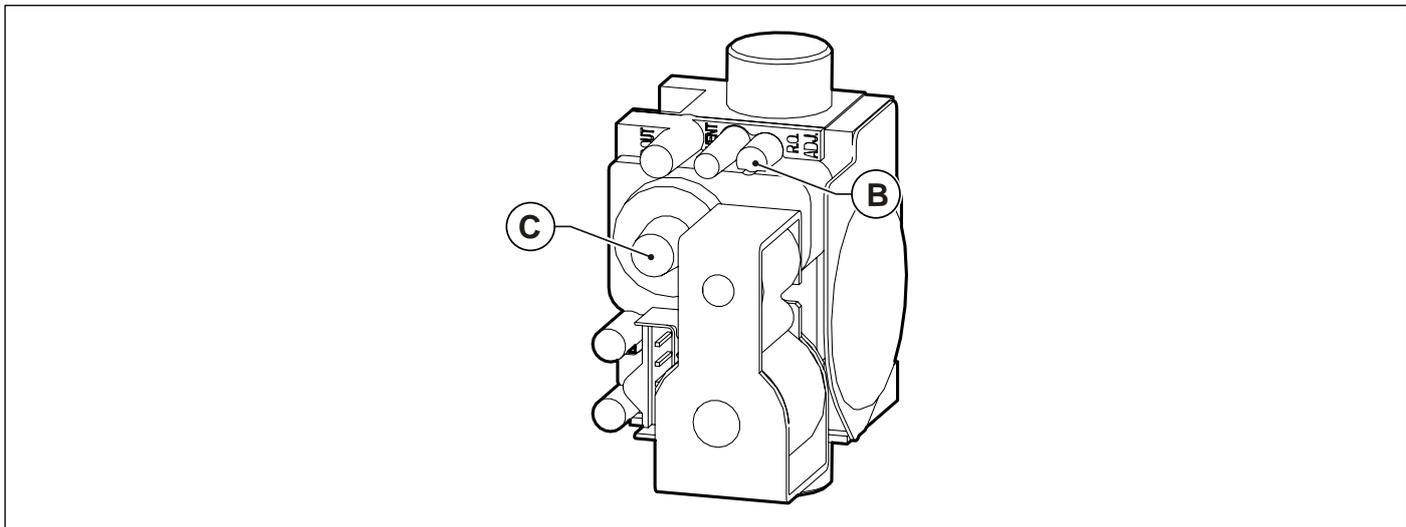
Fig. 36 Regolazione valore anidride carbonica
