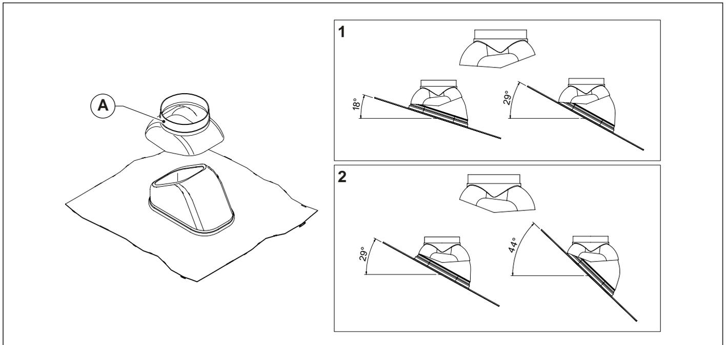
Fig. 13 Tegola per tetti inclinati
