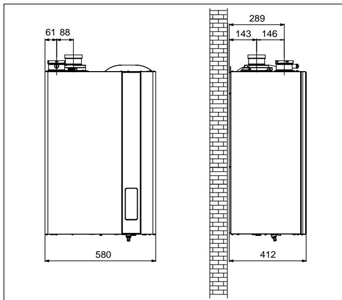
Fig. 18 Dimensioni condotti separati tipo C43 - C53 - C83
