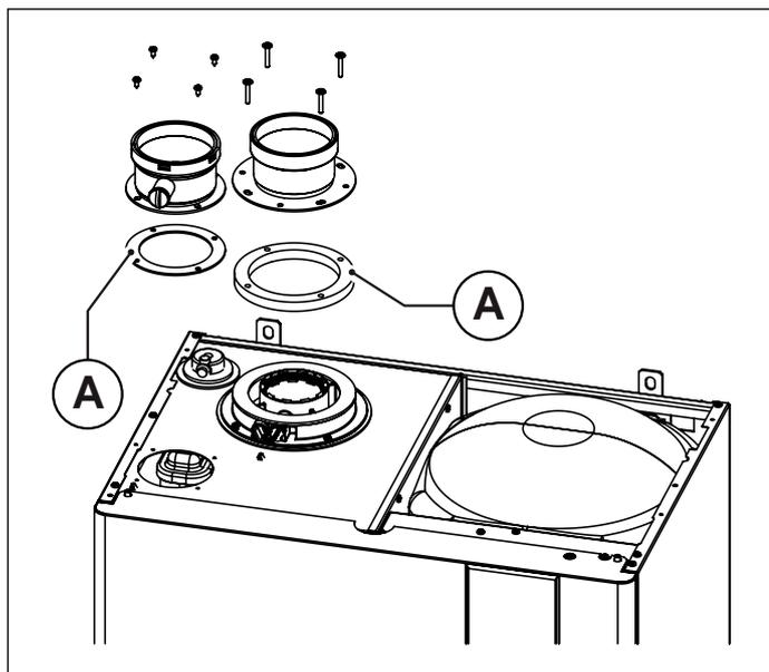
Fig. 17 Condotti separati tipo C43 - C53 - C83
