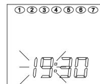
2. Con i tasti **+/- RISCALDAMENTO** è possibile modificare i valori che lampeggiano. Il primo valore da modificare sono le "ORE".
