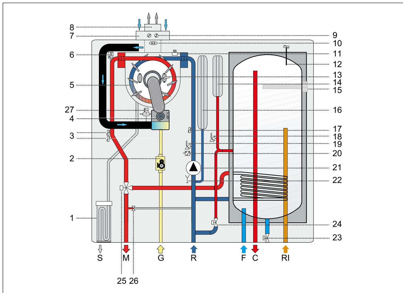
Fig. 5 Esquema hidráulico
