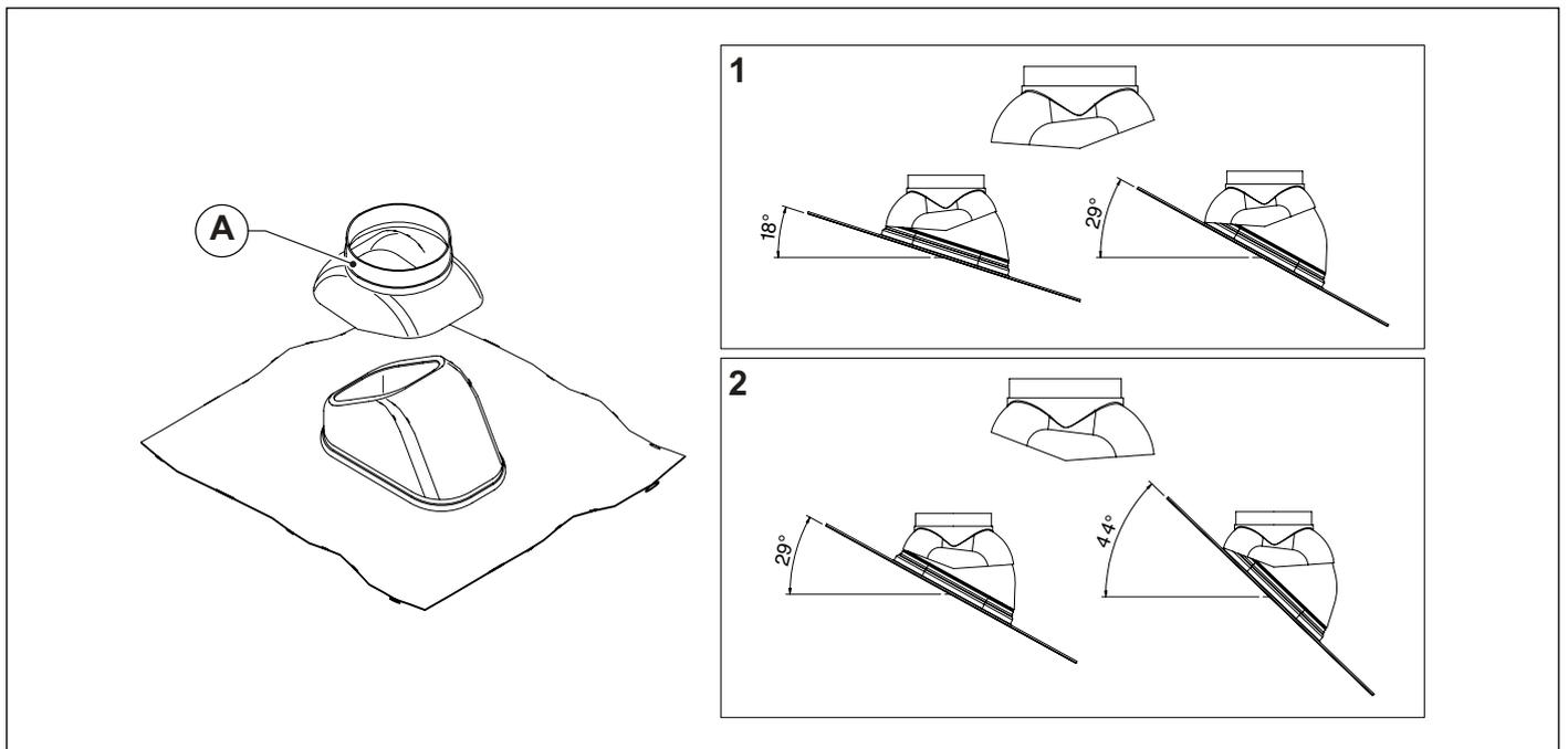
Fig. 13 Teja para techados inclinados
