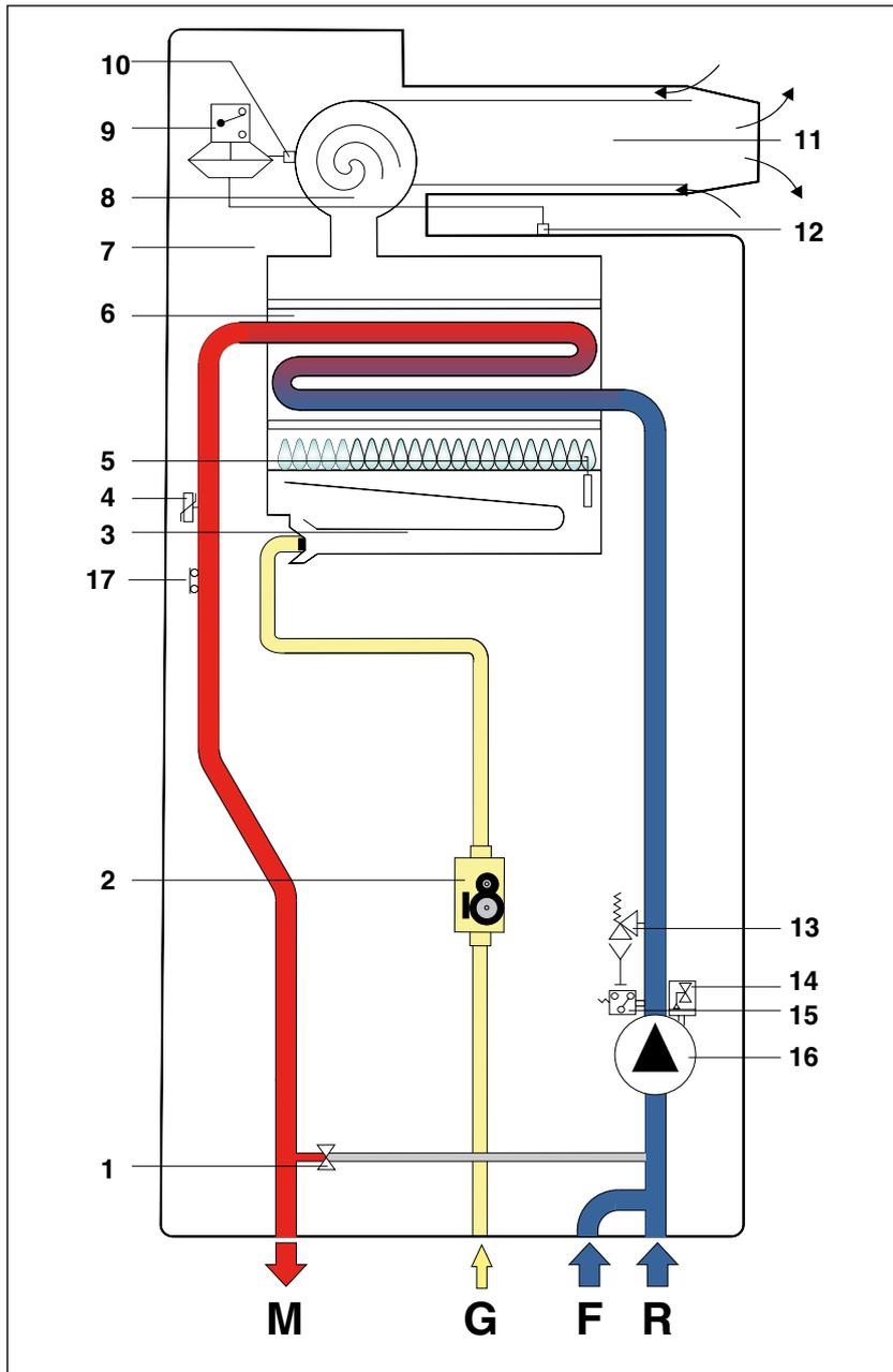
Fig. 5 Esquema hidráulico RTFS
