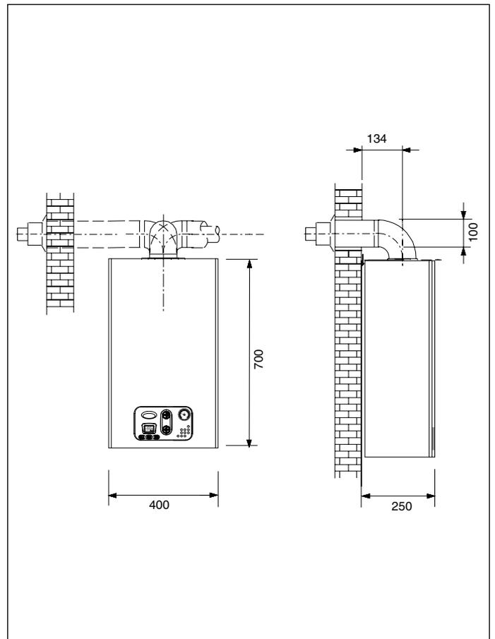
Fig. 9 Cotas dimensionales conductos coaxiales
