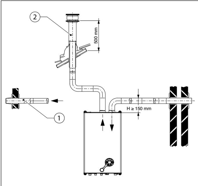
Fig. 10 Ejemplos de aspiración aire/descarga de humos
