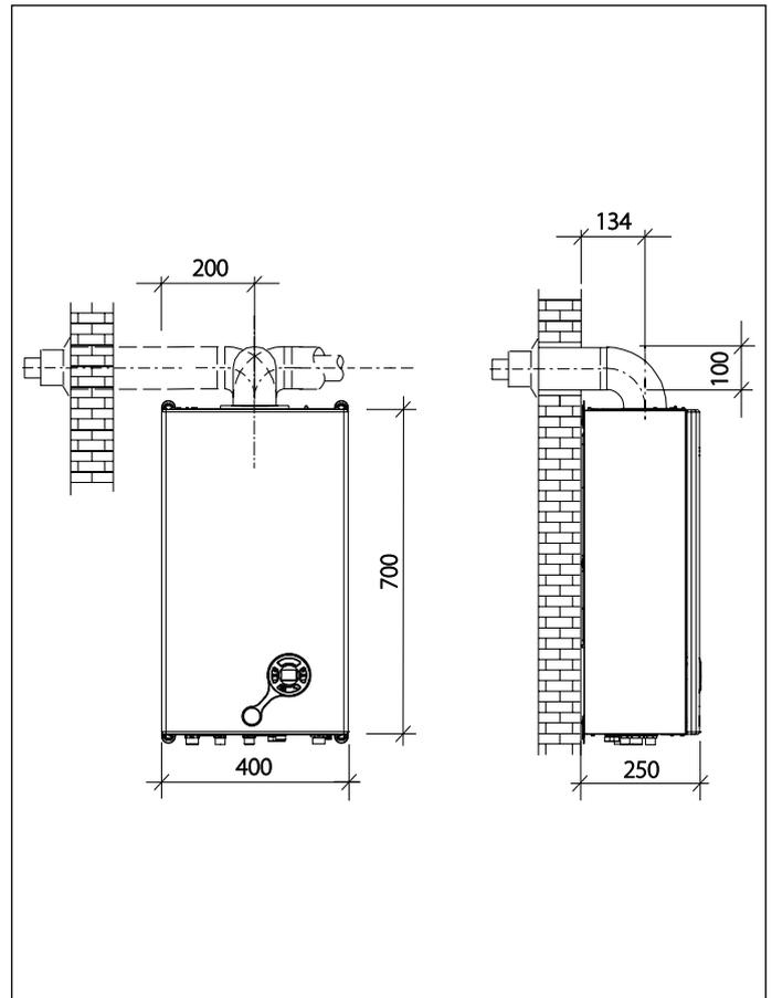
Fig. 7 Cotas dimensionales conductos coaxiales
