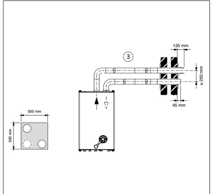
Fig. 11 Ejemplo de aspiración aire/descarga de humos
