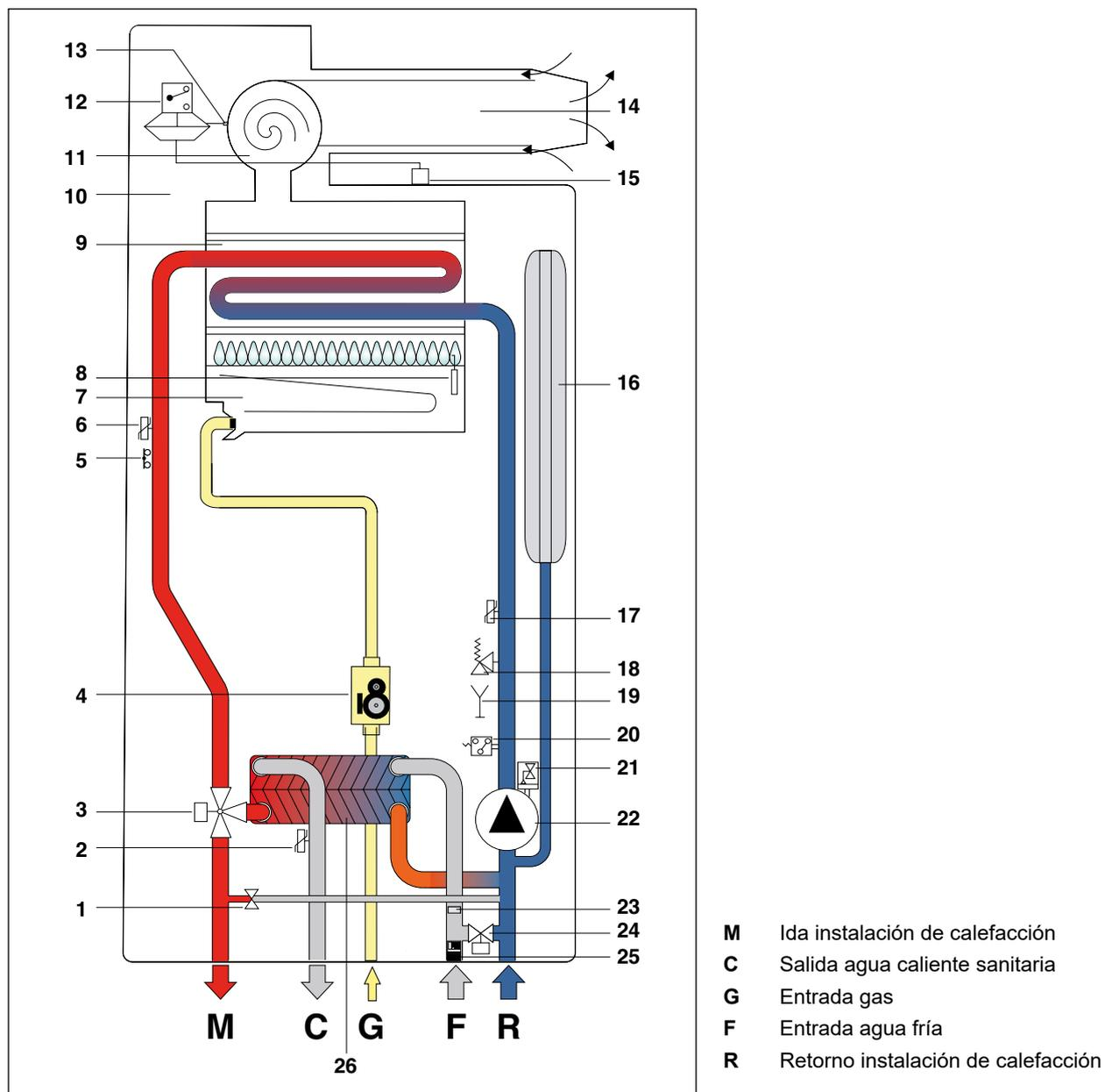
Fig. 4 Esquema hidráulico
