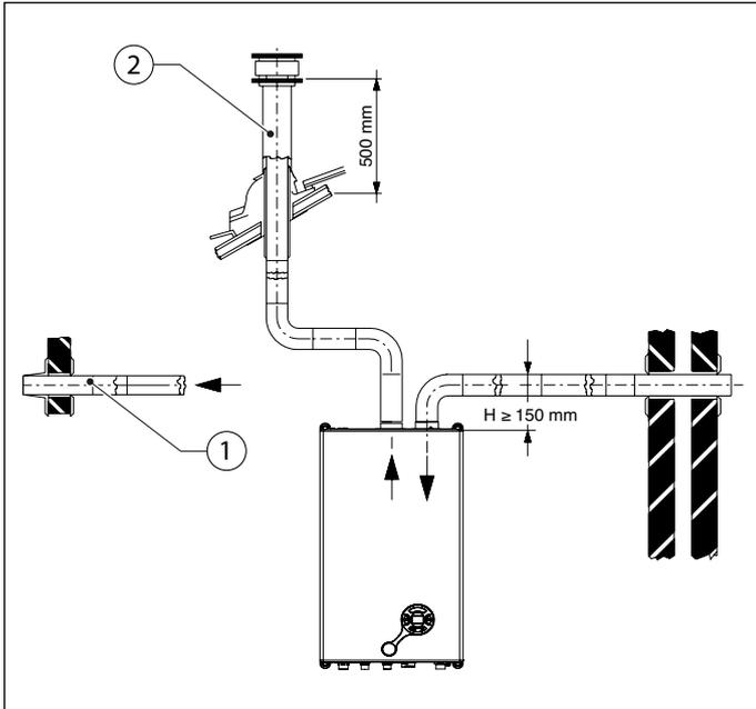
Fig. 10 Exemples d'aspiration de l'air/évacuation des fumées
