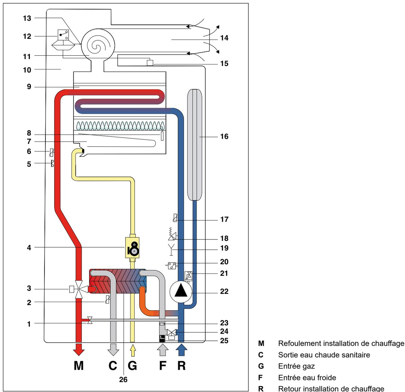
Fig. 4 Schéma hydraulique
