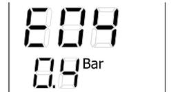
Lorsque le chargement automatique de l'installation sur l'afficheur s'active, l'afficheur visualise le symbole
