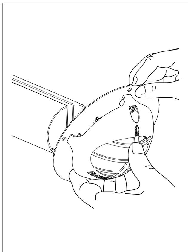
9. Infilare il terminale di scarico/aspirazione sulla tubazione assicurandosi che la scritta "made in Italy" sia leggibile correttamente nella parte bassa del terminale, al termine dell'operazione lo scarico deve apparire come nella figura di seguito riportata.
