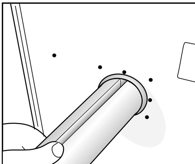
7. Afferrare la macchina, inserire i tubi di aspirazione e scarico attraverso il foro praticato a muro e fissare la macchina al muro utilizzando le apposite viti fornite in dotazione.
