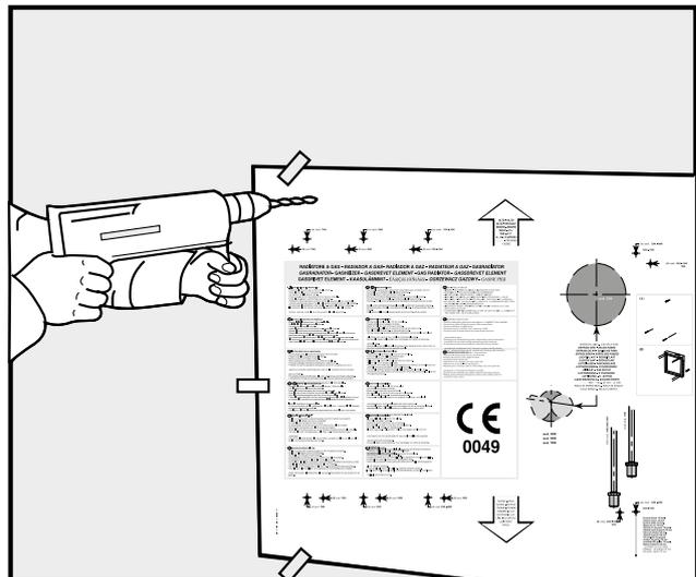
4. Misurare la profondità del foro praticato a muro per l'aspirazione e lo scarico e tagliare i tubi di aspirazione e scarico 5 cm più lunghi di quanto riscontrato a muro.
