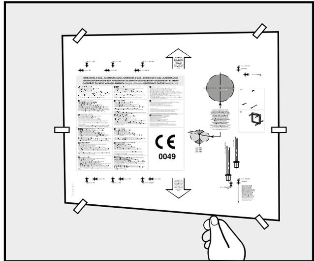
3. Forare il muro seguendo le indicazioni della dima, prestare attenzione in quanto le posizioni dei fori per il fissaggio e del foro per l'aspirazione e lo scarico variano da modello a modello.
