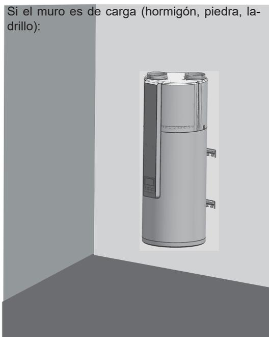
Marque la pared con referencia a los requisitos de las dimensiones de la instalación (plano acotado). Atornille los pernos  $\varnothing$  10 mm. El muro debe soportar una carga mínima de 300 kg.
