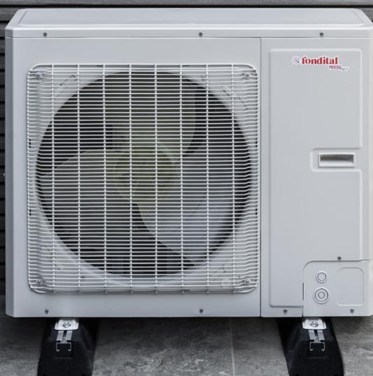
Per il corretto dimensionamento si deve considerare in primo luogo la potenza termica erogata, che è determinata da due fattori: la **temperatura esterna** e la **temperatura di mandata**, ovvero quella dell'impianto. Più è bassa la temperatura esterna, o molto elevata, minore è la resa (COP per il riscaldamento ed EER per il raffreddamento). Più la temperatura dell'acqua nell'impianto è alta minore sarà la resa della pompa di calore.
